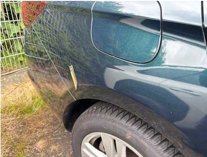
Seitenteil hinten rechts (Verformung)
