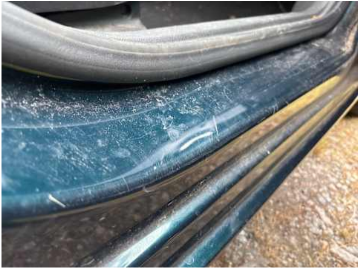
Schweller rechts (Kratzer)
