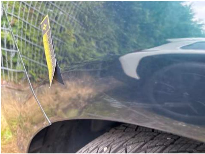
Seitenteil hinten rechts (Verformung)
