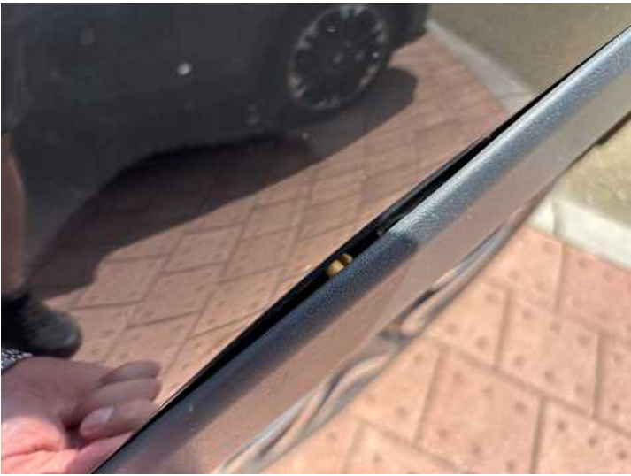
Kotflügel vorne rechts (Riss/Bruch)
