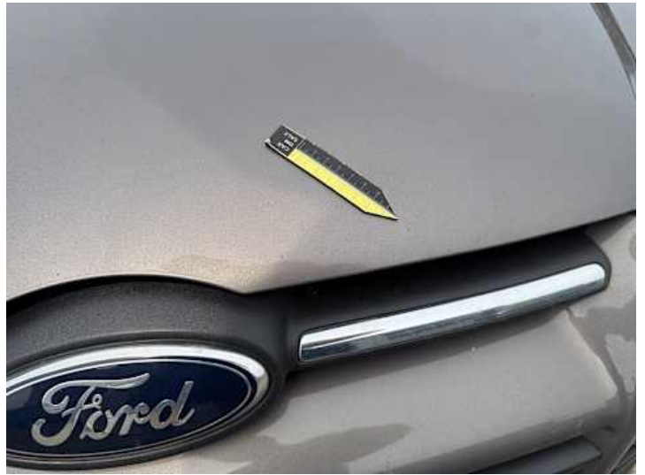
Motorhaube (Steinschlag, Rost)
