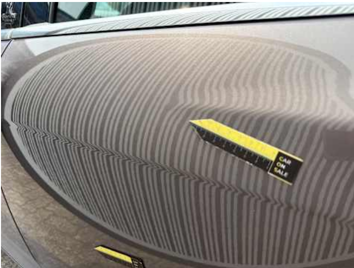
Türe hinten links (Delle)
