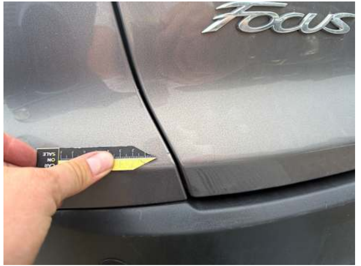
Stoßstange hinten (Unsachgemäß instand gesetzt)
