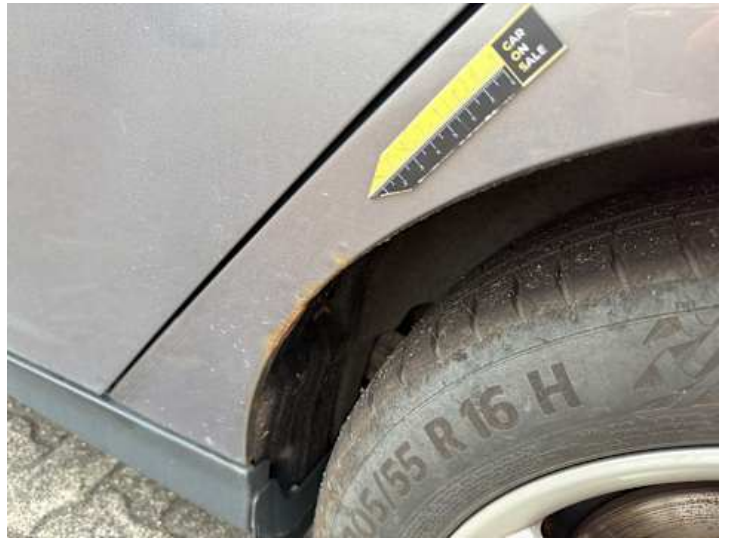
Seitenteil hinten links (Rost)
