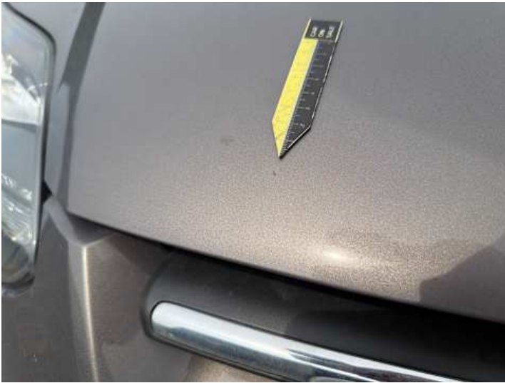
Motorhaube (Steinschlag, Rost)
