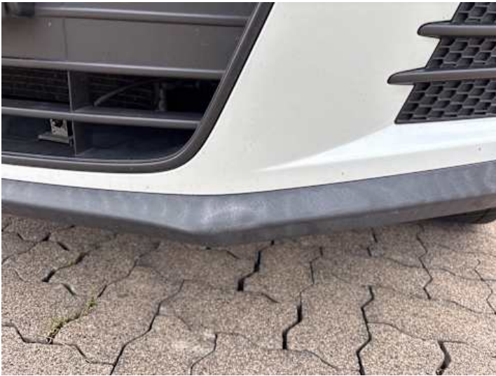
Stoßstange vorne (Kratzer, Delle)
