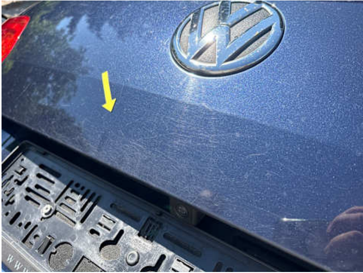
Heckklappe (Rost, Verformung, Unsachgemäß instand gesetzt)
