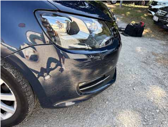
Stoßstange vorne (Kratzer, Lackschaden, Spaltmaße ungenau, Verformung)
