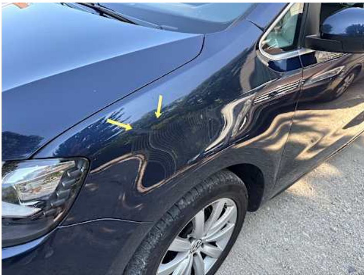
Kotflügel vorne links (Kratzer)
