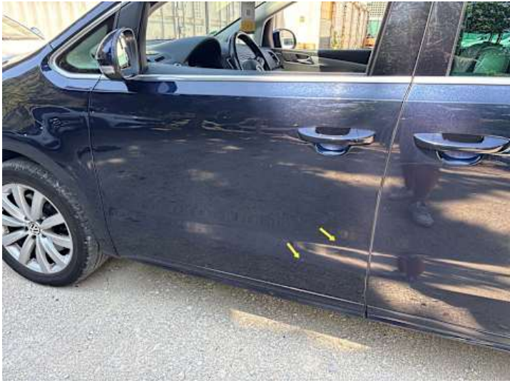
Fahrtür (Kratzer, Delle, Lackschaden)
