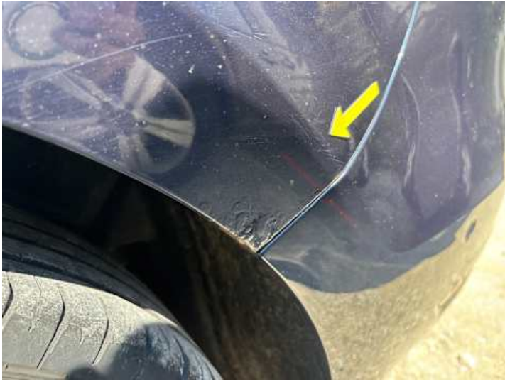
Seitenteil hinten links (Rost, Kratzer)
