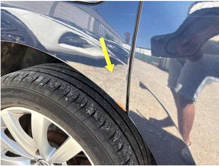
Seitenteil hinten rechts (Rost, Ausgeblichen/Matt)
