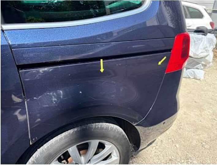
Seitenteil hinten links (Rost, Kratzer)
