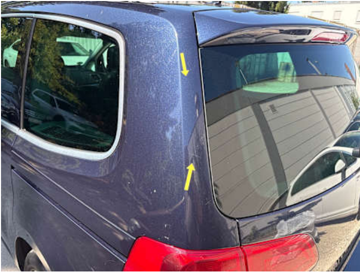
Seitenteil hinten links (Rost, Kratzer)
