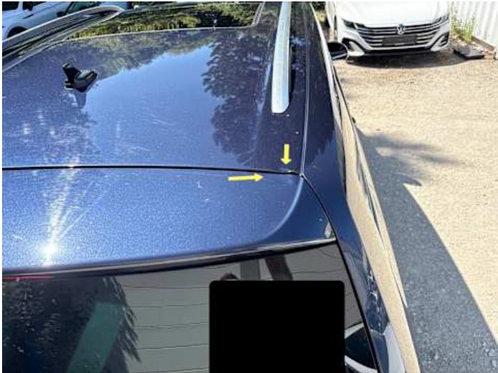
Dach (Unsachgemäß instand gesetzt, Verformung, Lackschaden, Rost)
