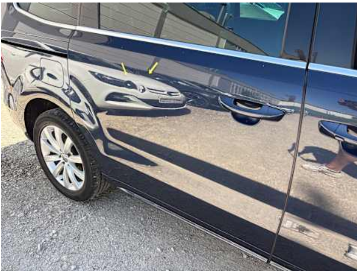
Türe hinten rechts (Delle)
