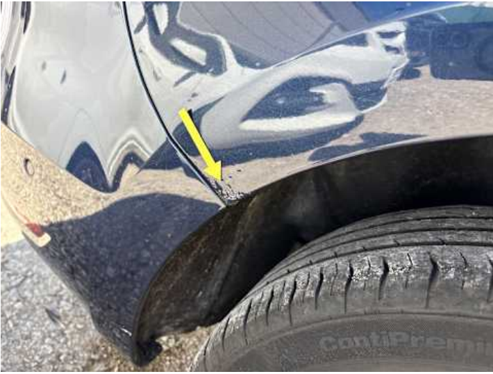
Seitenteil hinten rechts (Rost, Ausgeblichen/Matt)
