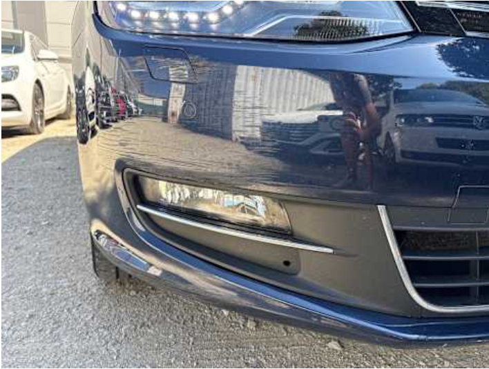
Stoßstange vorne (Kratzer, Lackschaden, Spaltmaße ungenau, Verformung)
