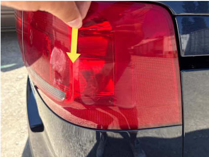
Rücklicht (rechts) (Kratzer)
