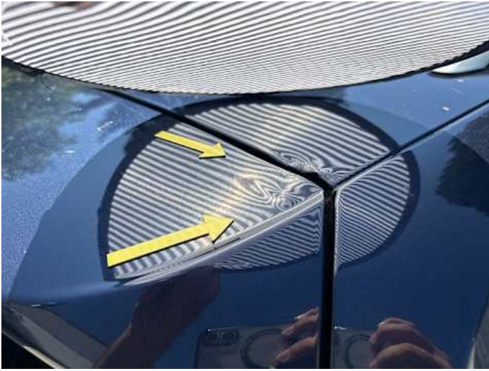
Heckklappe (Rost, Verformung, Unsachgemäß instand gesetzt)
