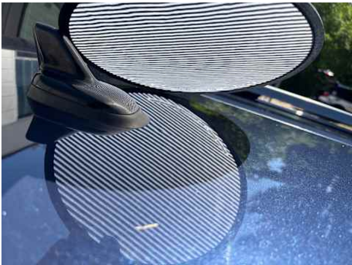
Dach (Unsachgemäß instand gesetzt, Verformung, Lackschaden, Rost)
