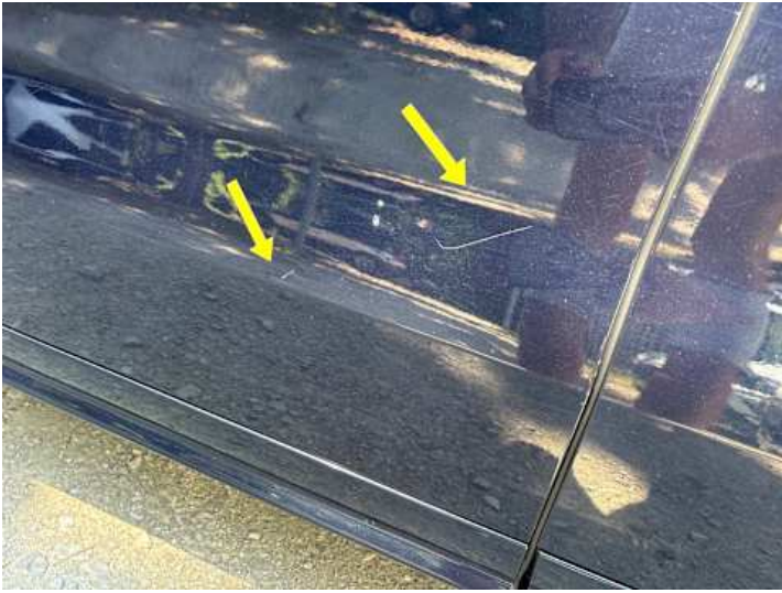
Fahrtür (Kratzer, Delle, Lackschaden)
