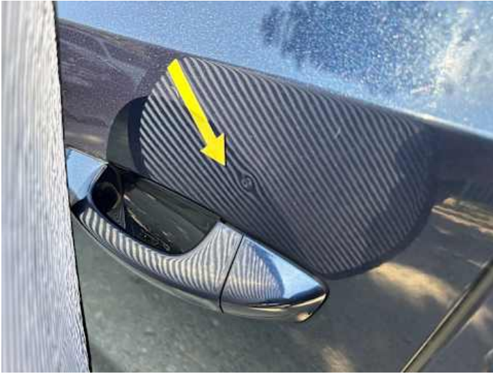
Fahrtür (Kratzer, Delle, Lackschaden)
