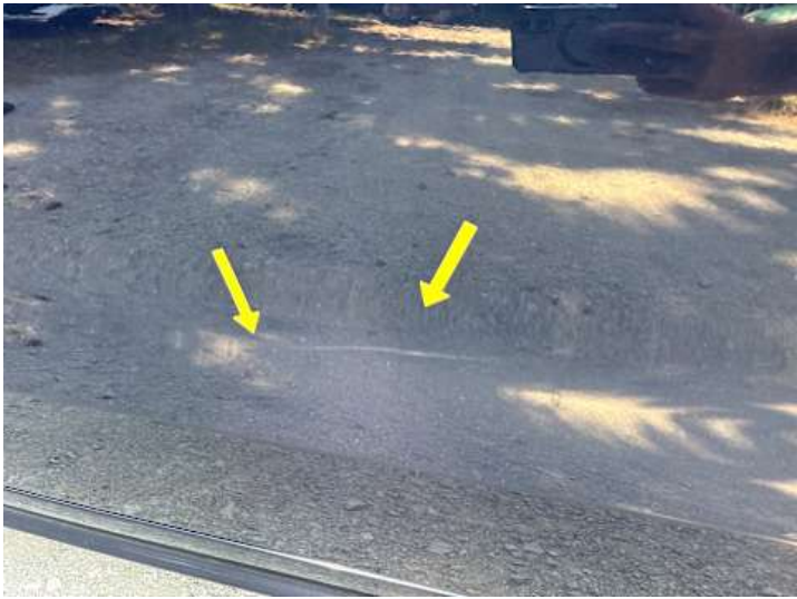
Fahrtür (Kratzer, Delle, Lackschaden)
