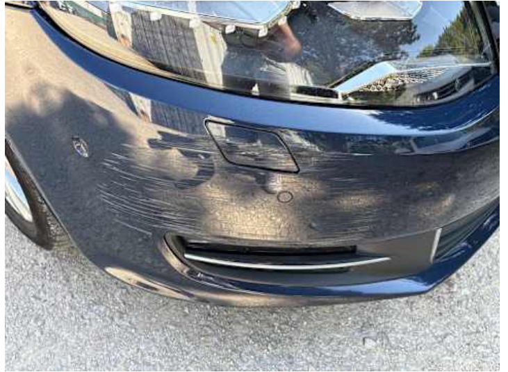
Stoßstange vorne (Kratzer, Lackschaden, Spaltmaße ungenau, Verformung)
