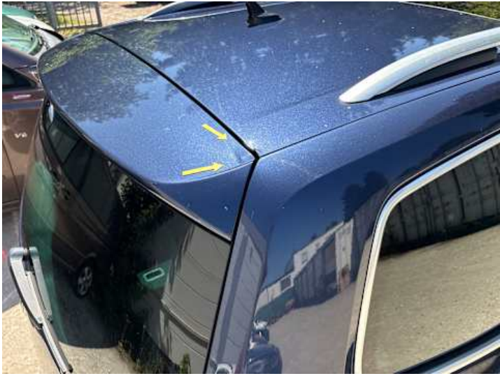
Heckklappe (Rost, Verformung, Unsachgemäß instand gesetzt)
