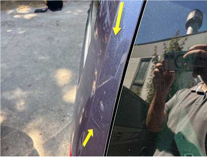
Seitenteil hinten links (Rost, Kratzer)
