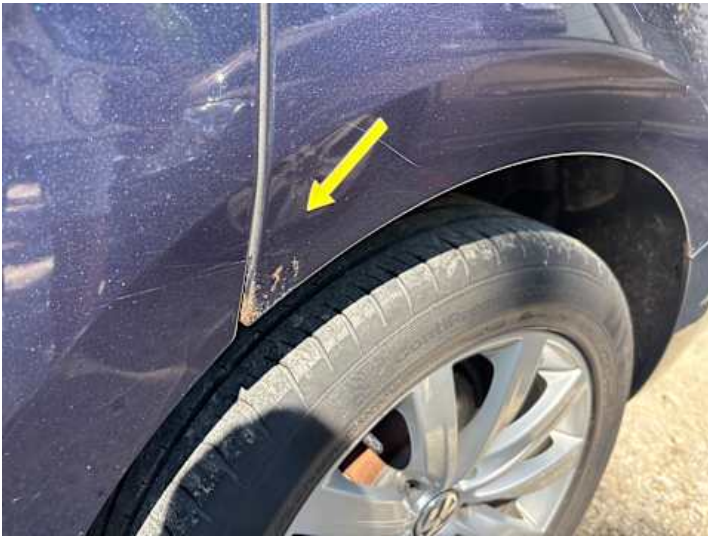
Seitenteil hinten links (Rost, Kratzer)
