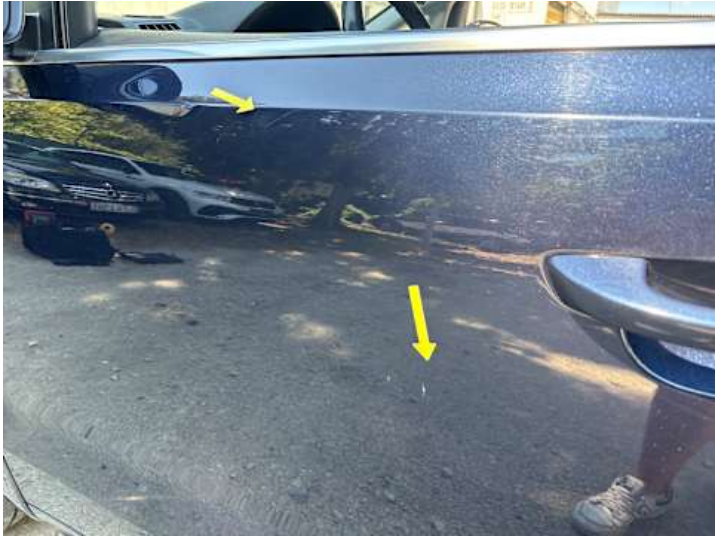
Fahrtür (Kratzer, Delle, Lackschaden)
