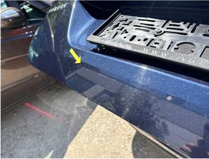
Heckklappe (Rost, Verformung, Unsachgemäß instand gesetzt)
