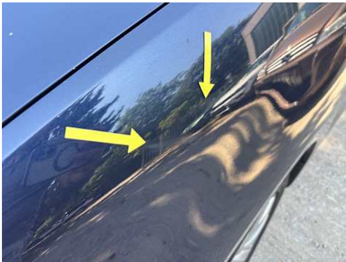
Kotflügel vorne links (Kratzer)
