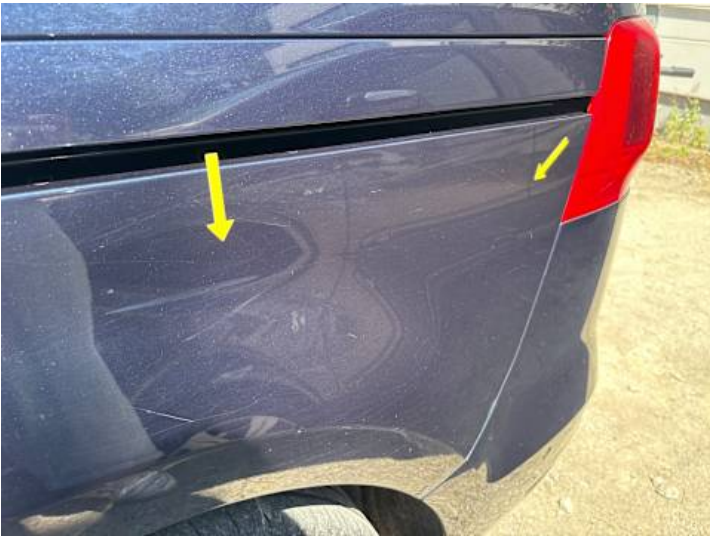
Seitenteil hinten links (Rost, Kratzer)
