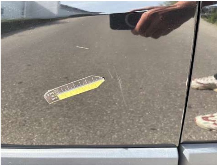
Fahrtür (Lackschaden, Kratzer)
