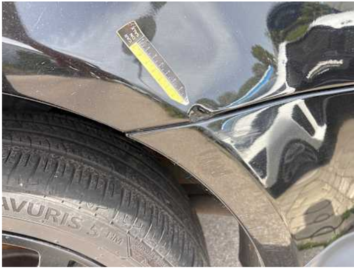
Seitenteil hinten links (Verformung, Kratzer, Lackschaden)
