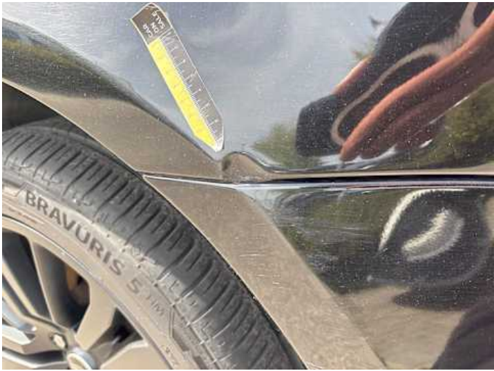
Seitenteil hinten links (Verformung, Kratzer, Lackschaden)
