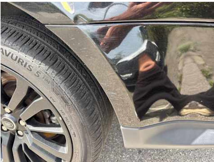
Stoßstange hinten (Kratzer, Lackschaden, Unsachgemäß instand gesetzt)
