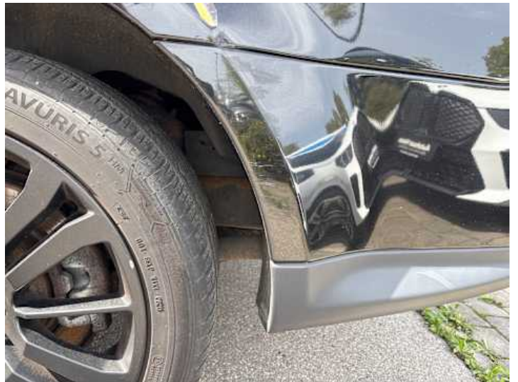
Stoßstange hinten (Kratzer, Lackschaden, Unsachgemäß instand gesetzt)
