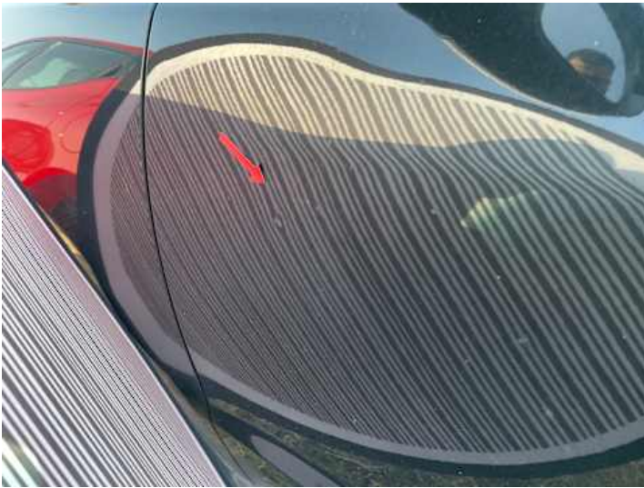
Fahrrertür (Delle, Kratzer)
