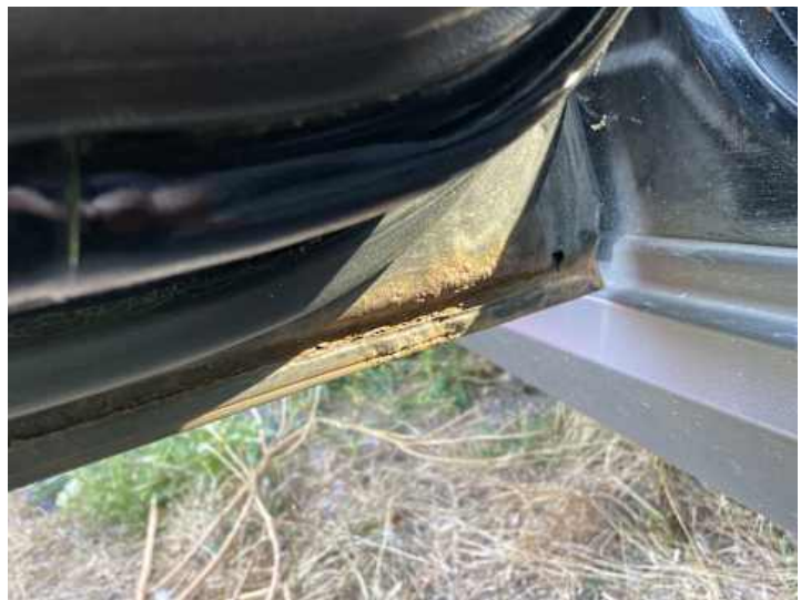
Türe hinten links (Rost)
