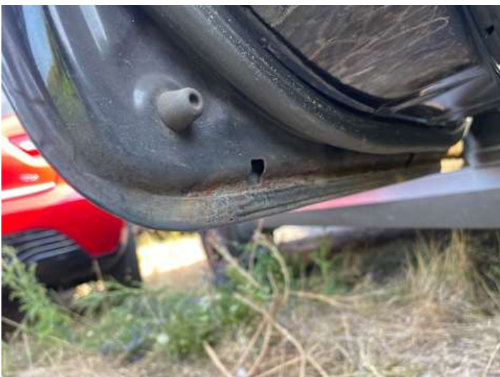
Türe hinten links (Rost)
