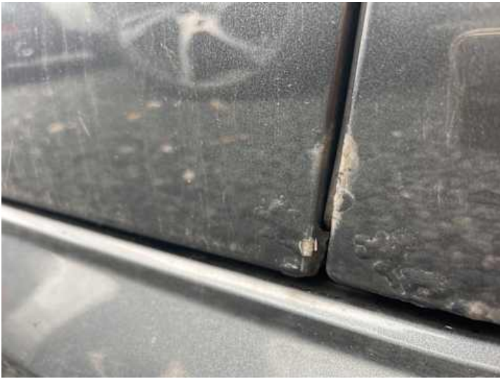
Türe hinten rechts (Rost)
