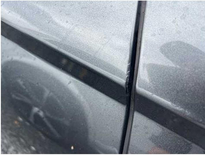
Türe hinten rechts (Rost)
