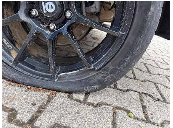
Rad (Riss/Bruch, Ohne Luft)
