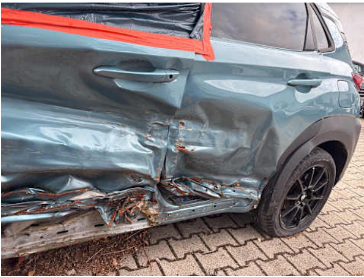
Türe hinten links (Lackschaden, Riss/Bruch, Verformung)
