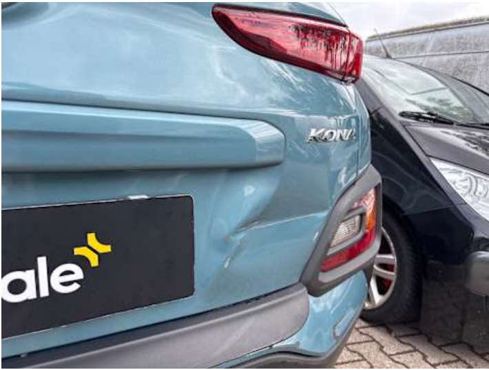
Heckklappe (Lackschaden, Verformung)
