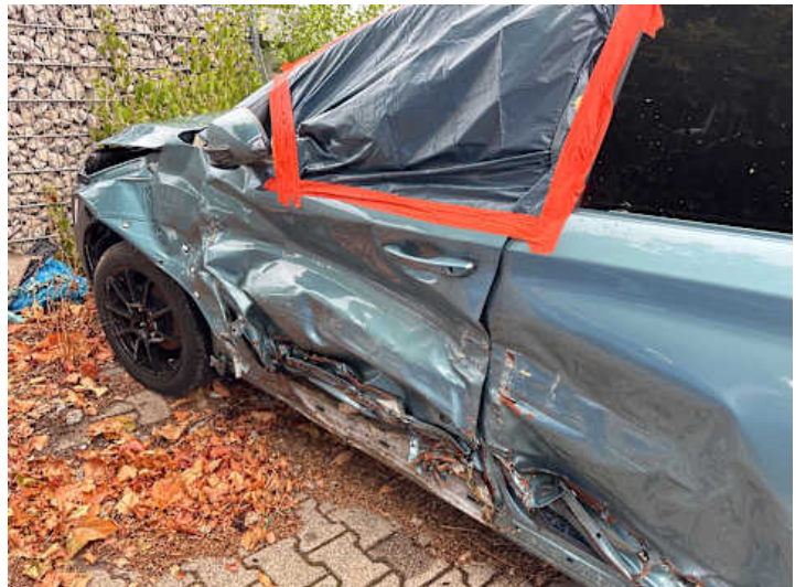
Fahrtür (Riss/Bruch, Lackschaden, Verformung)
