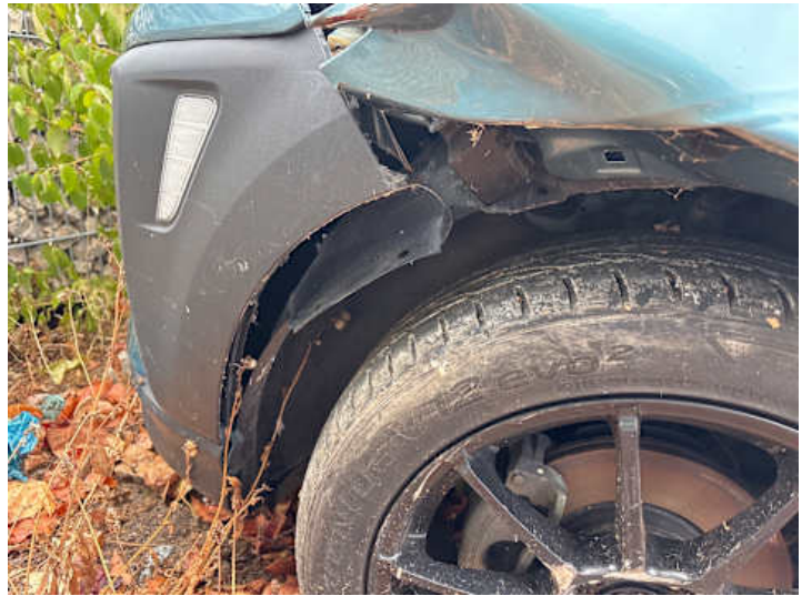
Stoßstange vorne (Riss/Bruch, Spaltmaße ungenau)
