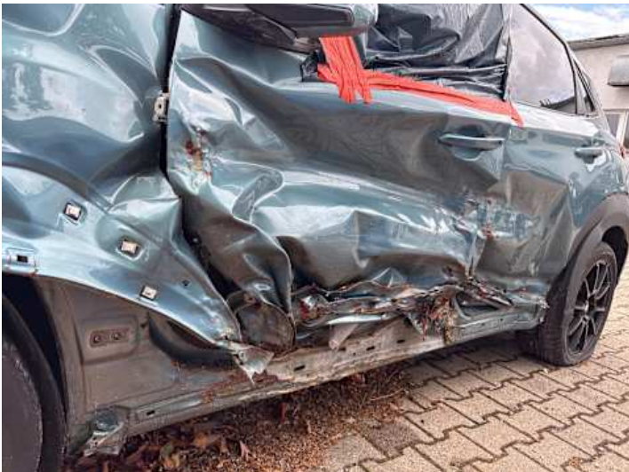
Fahrtür (Riss/Bruch, Lackschaden, Verformung)
