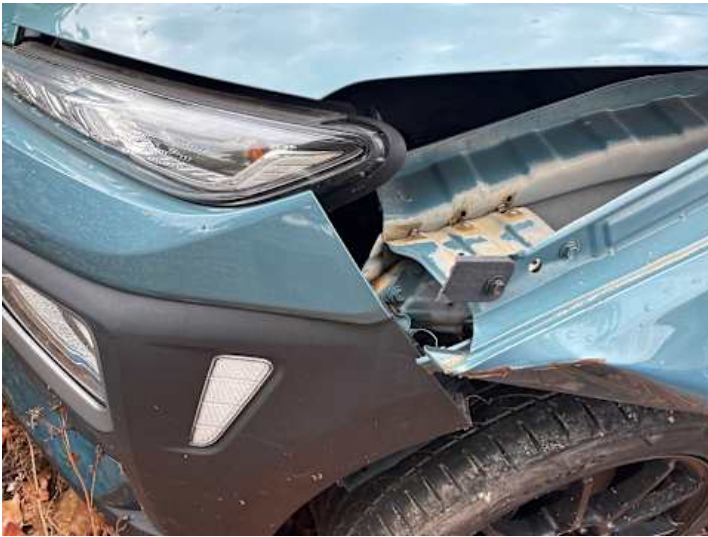
Stoßstange vorne (Riss/Bruch, Spaltmaße ungenau)
