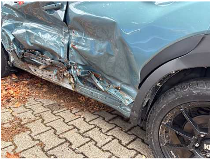
Türe hinten links (Lackschaden, Riss/Bruch, Verformung)
