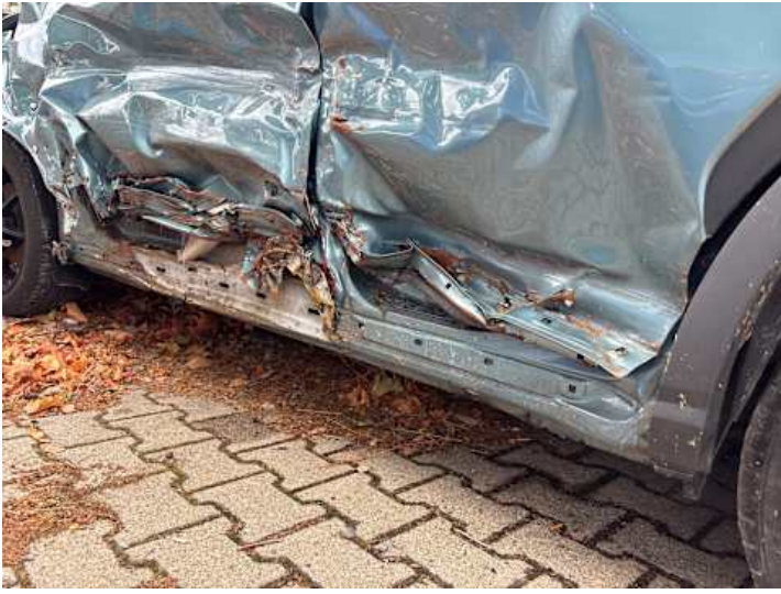
Schweller links (Lackschaden, Riss/Bruch, Verformung)
