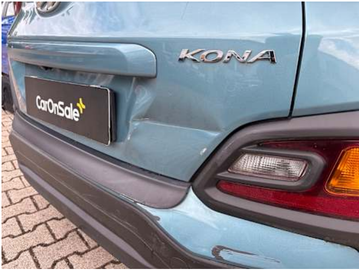
Heckklappe (Lackschaden, Verformung)
