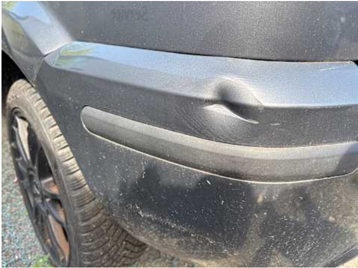
Stoßstange hinten (Verformung, Lackschaden)
