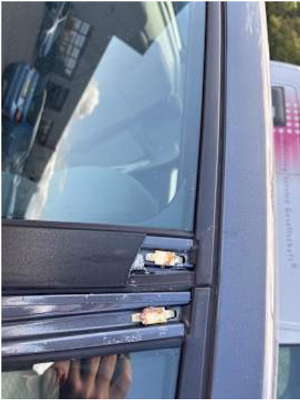
Türe hinten rechts (Riss/Bruch)
