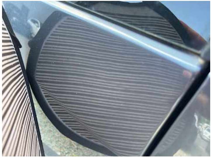
Seitenteil hinten rechts (Delle)
