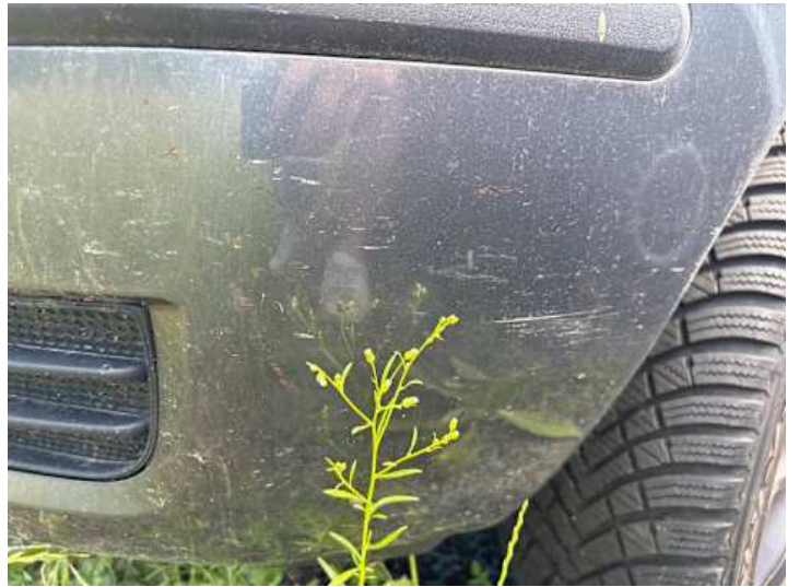
Stoßstange vorne (Kratzer, Lackschaden)
