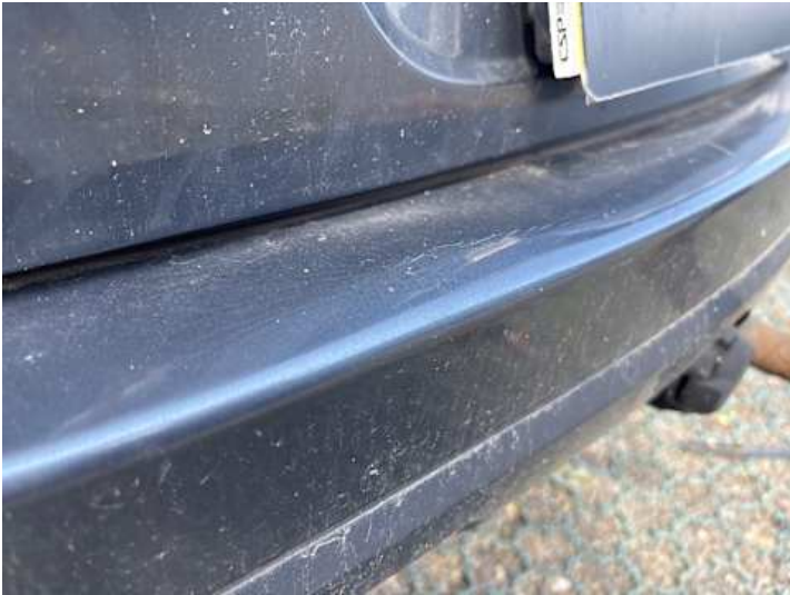
Stoßstange hinten (Verformung, Lackschaden)
