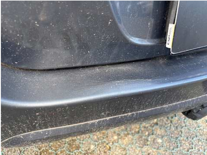
Stoßstange hinten (Verformung, Lackschaden)
