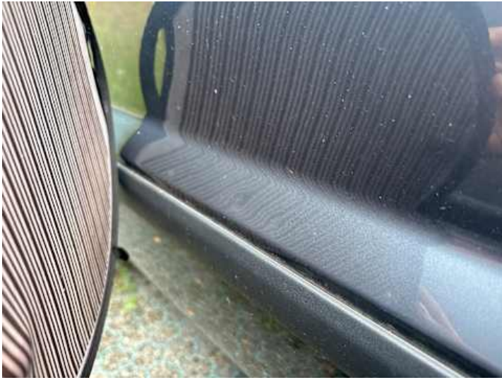
Fahrtür (Delle, Verformung)
