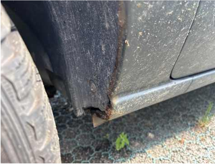
Kotflügel vorne links (Rost, Lackschaden)
