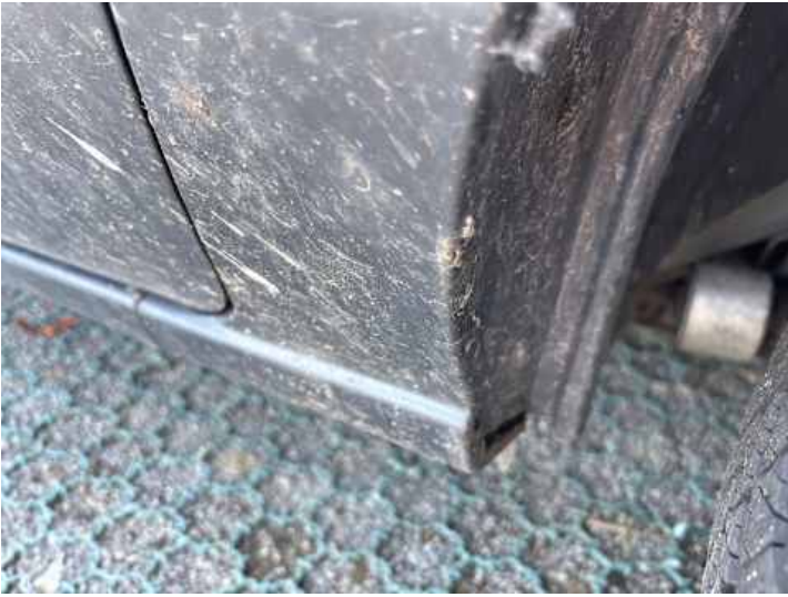
Kotflügel vorne rechts (Kratzer, Rost, Lackschaden)
