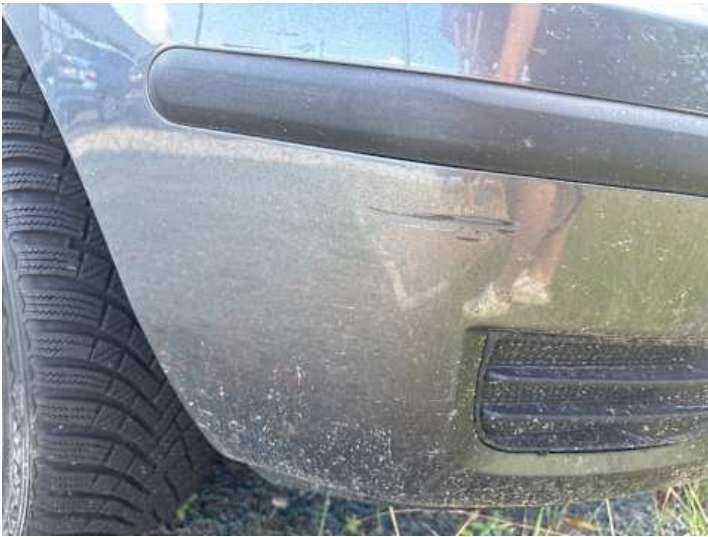
Stoßstange vorne (Kratzer, Lackschaden)
