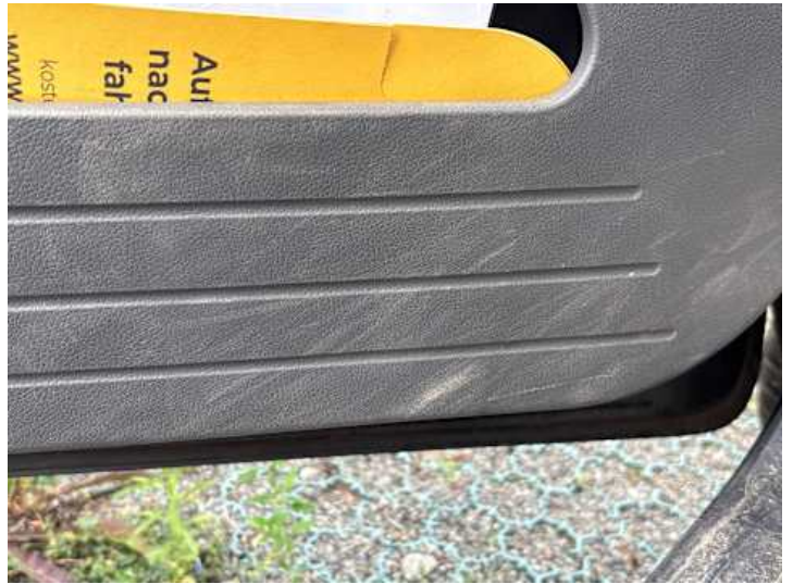
Innenraum (Kratzer, Verschleiß)
