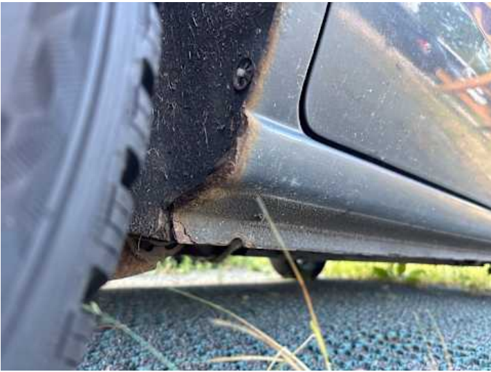
Schweller rechts (Lackschaden, Rost)
