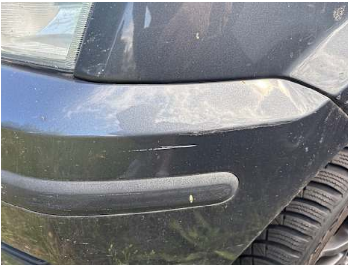
Stoßstange vorne (Kratzer, Lackschaden)
