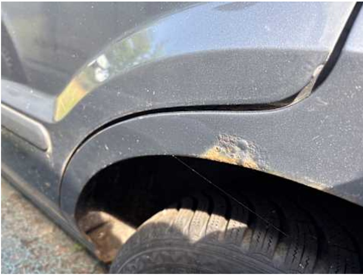
Seitenteil hinten links (Lackschaden, Rost)
