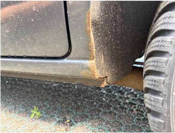
Schweller links (Rost, Lackschaden)
