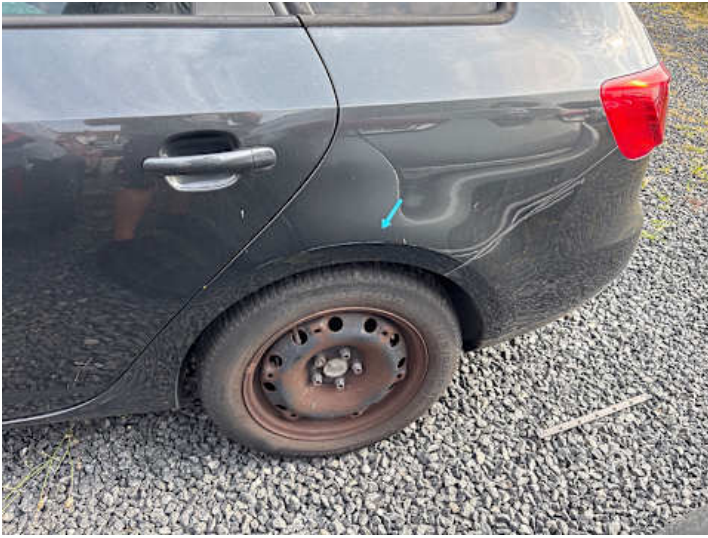
Seitenteil hinten links (Lackschaden)
