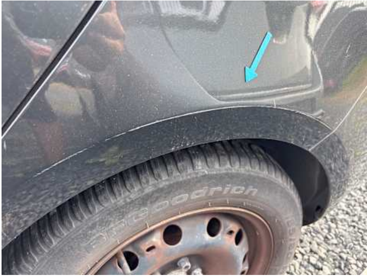
Seitenteil hinten links (Lackschaden)
