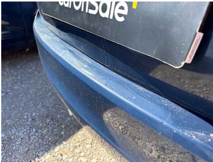
Stoßstange hinten (Lackschaden, Unsachgemäß instand gesetzt, Riss/Bruch)
