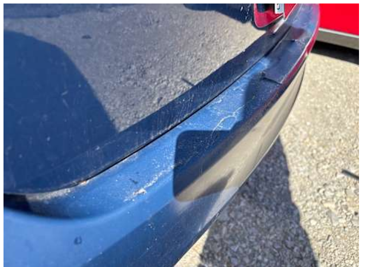
Stoßstange hinten (Lackschaden, Unsachgemäß instand gesetzt, Riss/Bruch)
