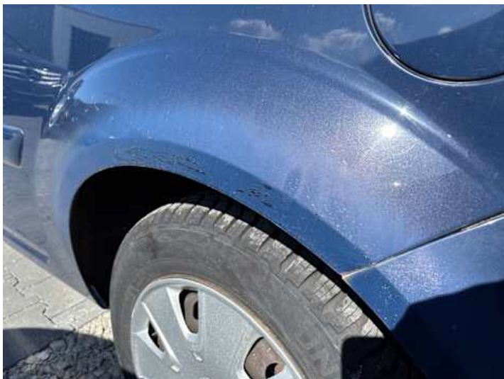
Seitenteil hinten links (Lackschaden, Unsachgemäß instand gesetzt)
