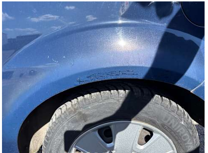
Seitenteil hinten links (Lackschaden, Unsachgemäß instand gesetzt)
