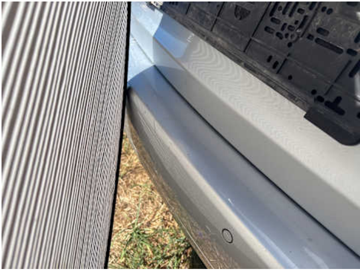
Stoßstange hinten (Verformung, Kratzer)
