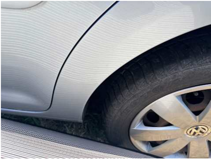
Seitenteil hinten links (Verformung)
