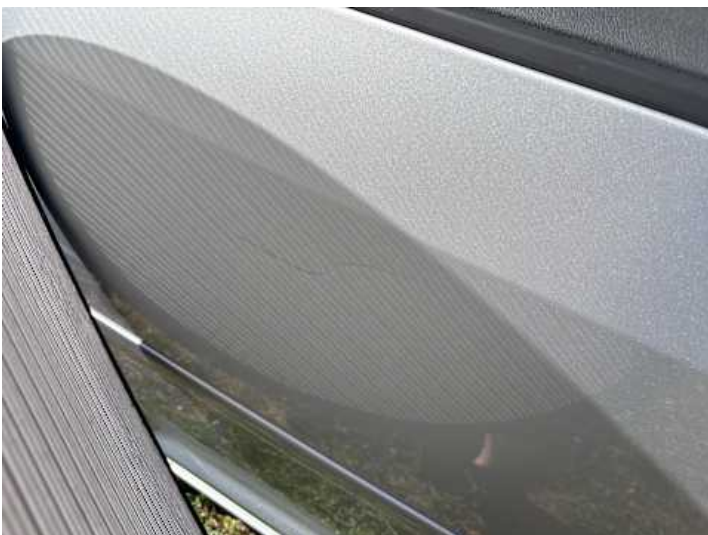
Türe hinten rechts (Verformung, Kratzer)
