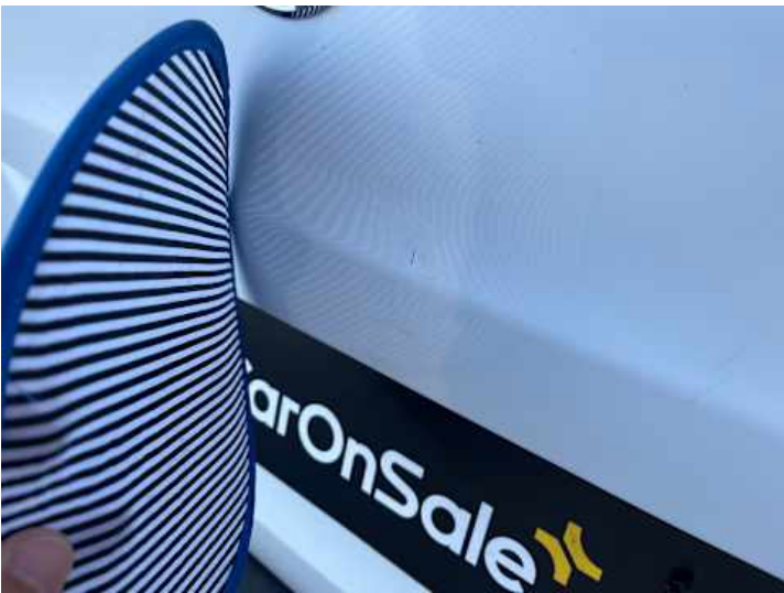
Heckklappe (Delle, Kratzer)
