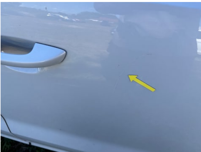
Türe hinten links (Kratzer)
