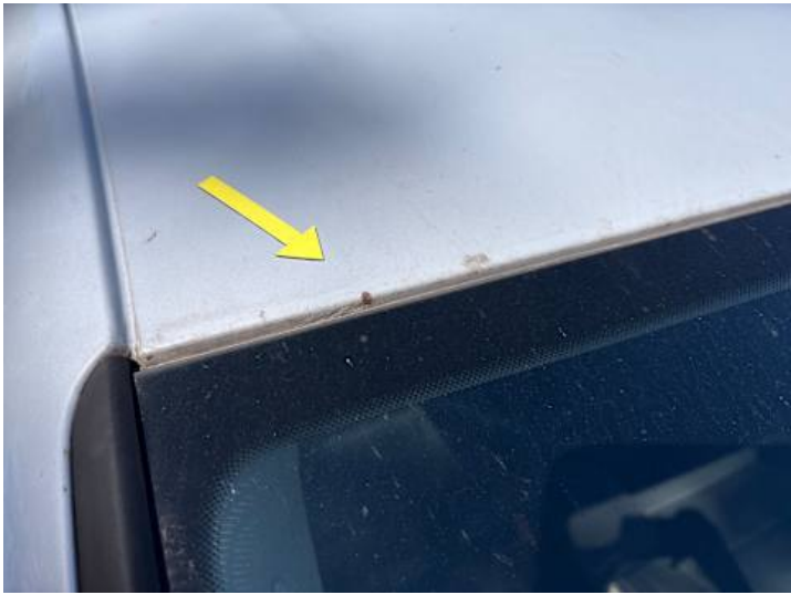
Dach (Lackschaden, Rost)
