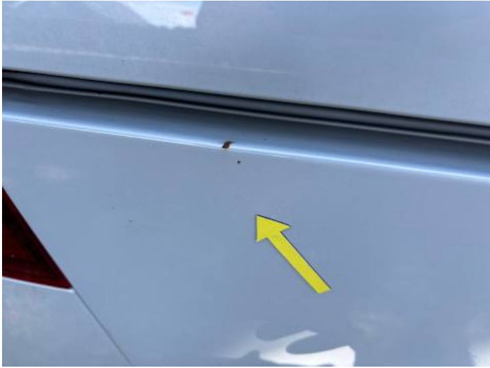
Seitenteil hinten rechts (Lackschaden, Rost)
