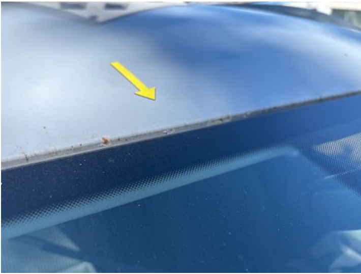
Dach (Lackschaden, Rost)
