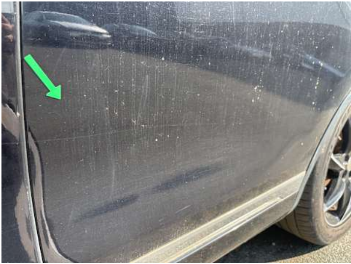
Türe hinten links (Kratzer)
