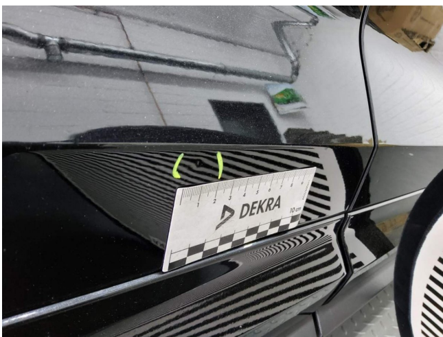
Tür hinten rechts, eingedellt, Gebrauchsspur (DEKRA)
