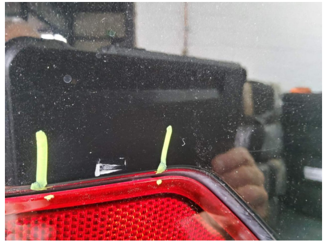
Stoßfänger hinten Lackierung, verschrammt, smart repair (DEKRA)
