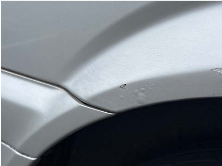
Seitenteil hinten rechts (Rost, Lackschaden, Kratzer, Verformung, Unsachgemäß instand gesetzt)
