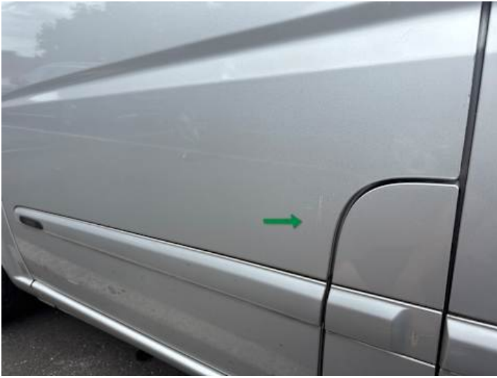
Fahrtür (Lackschaden, Kratzer)
