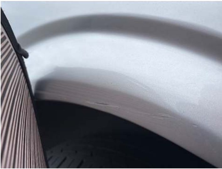
Seitenteil hinten rechts (Rost, Lackschaden, Kratzer, Verformung, Unsachgemäß instand gesetzt)
