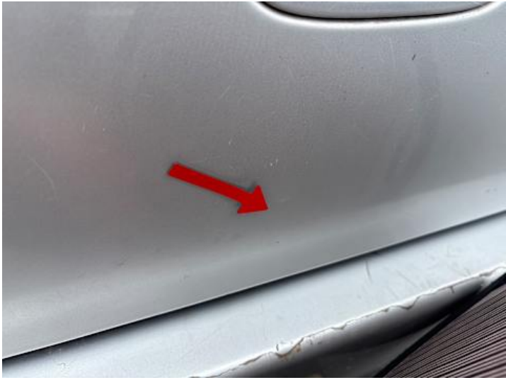
Heckklappe (Delle, Verformung)
