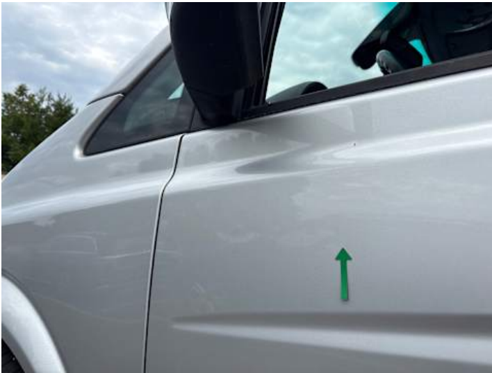
Fahrtür (Lackschaden, Kratzer)
