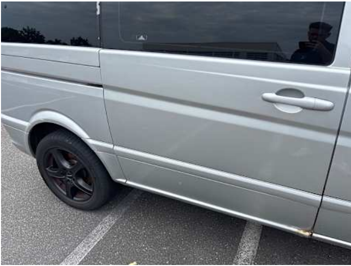
Türe hinten rechts (Lackschaden, Unsachgemäß instand gesetzt)
