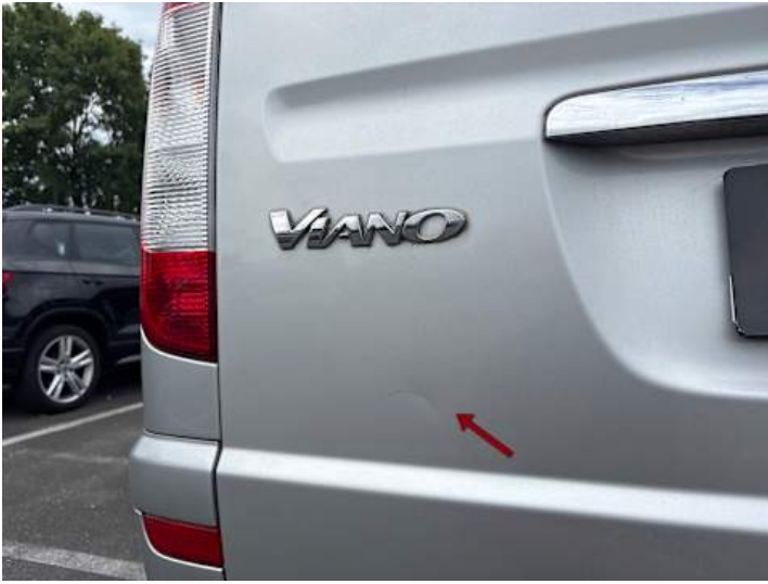
Heckklappe (Delle, Verformung)
