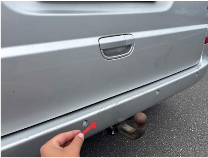
Stoßstange hinten (Kratzer, Lackschaden, Verformung)
