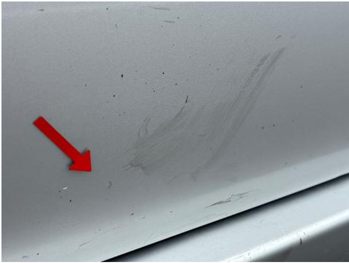
Heckklappe (Kratzer, Lackschaden)
