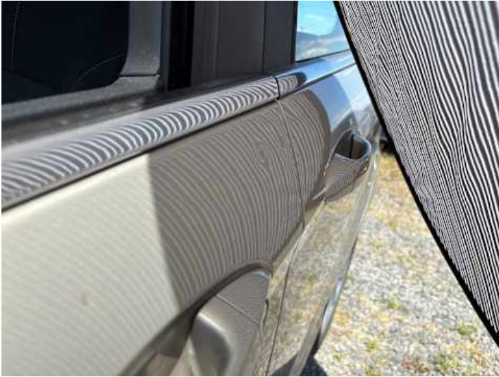
Fahrertür (Unsachgemäß instand gesetzt, Delle)
