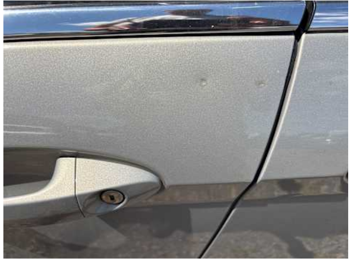
Fahrertür (Unsachgemäß instand gesetzt, Delle)
