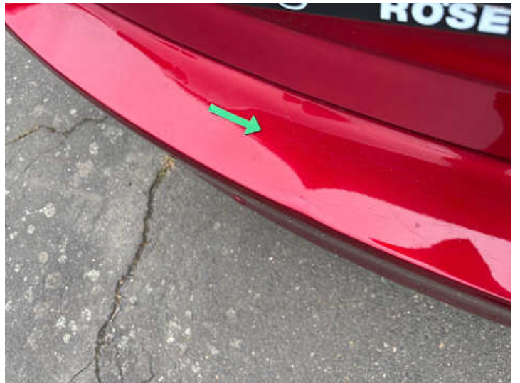
Stoßstange hinten (Verformung, Lackschaden)
