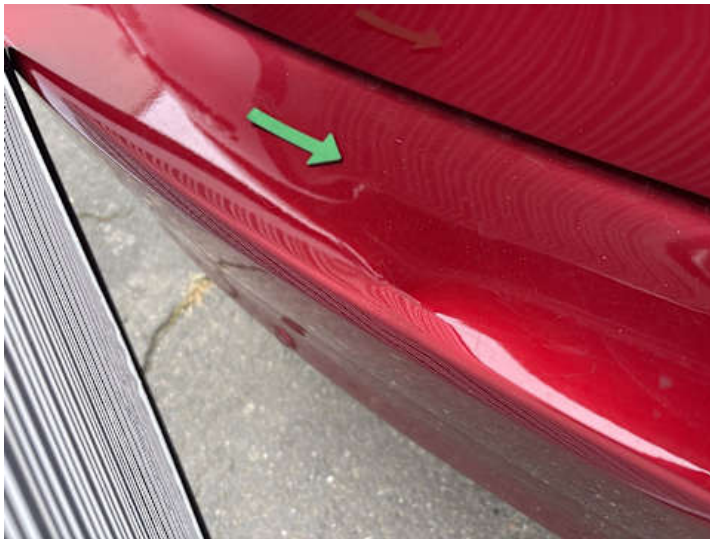
Stoßstange hinten (Verformung, Lackschaden)
