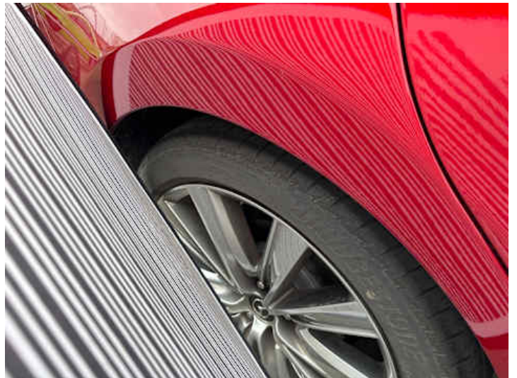
Seitenteil hinten rechts (Unsachgemäß instand gesetzt)
