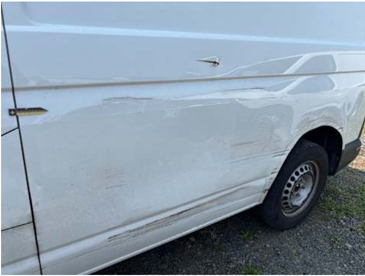
Seitenteil hinten links (Kratzer, Verformung, Rost)
