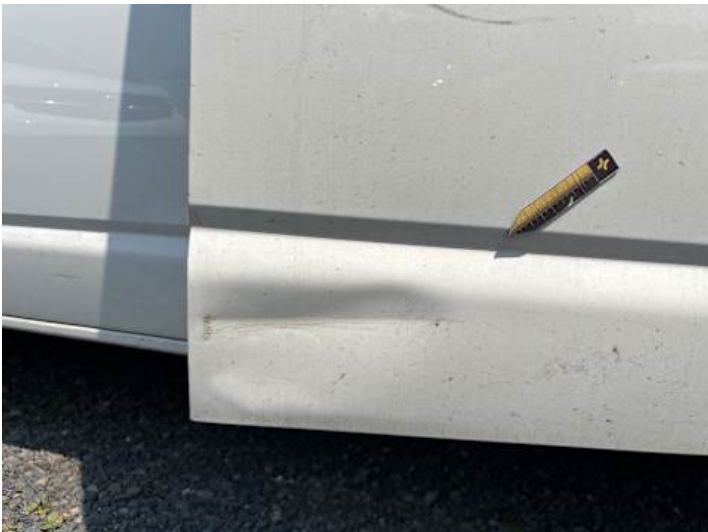
Beifahrtür (Rost, Verformung)
