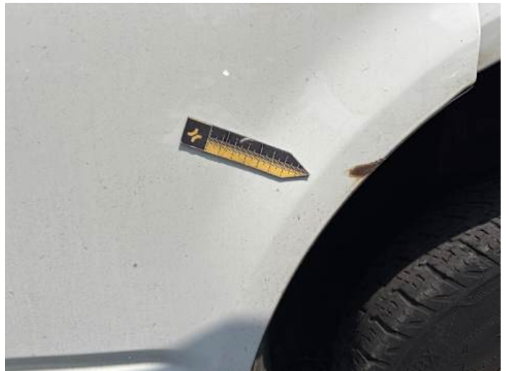
Beifahrtür (Rost, Verformung)
