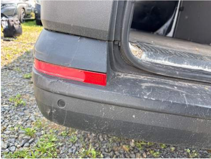
Stoßstange hinten (Verformung, Riss/Bruch)
