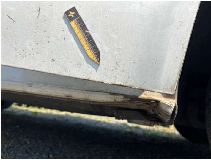
Beifahrertür (Rost, Verformung)
