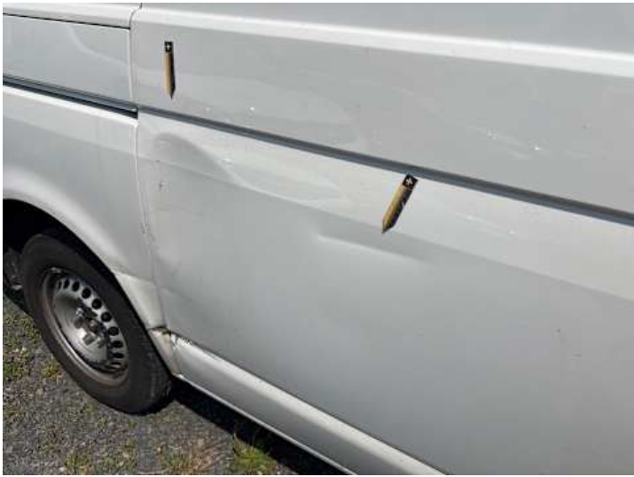
Türe hinten rechts (Verformung, Kratzer)
