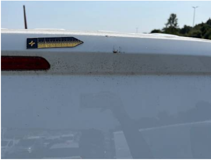
Heckklappe (Delle, Kratzer, Rost)
