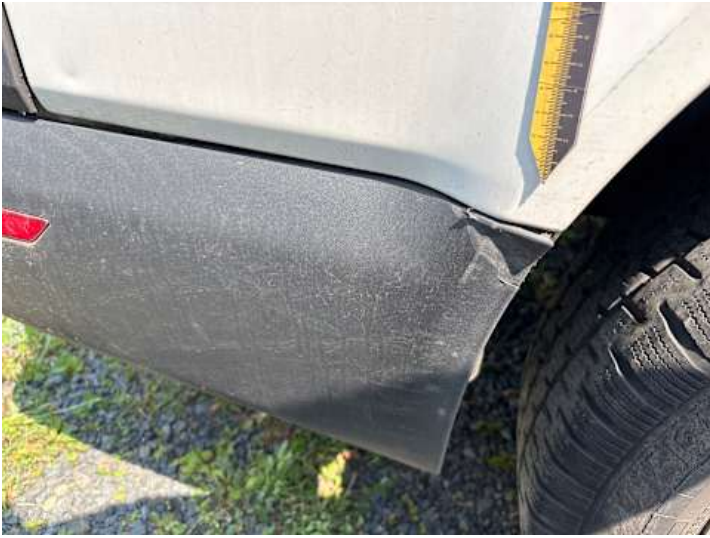
Stoßstange hinten (Verformung, Riss/Bruch)
