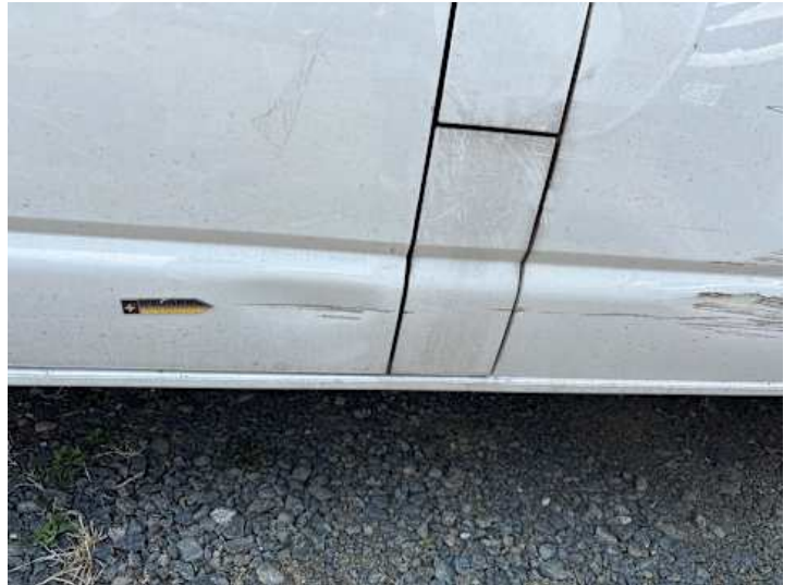
Fahrtür (Kratzer, Verformung)
