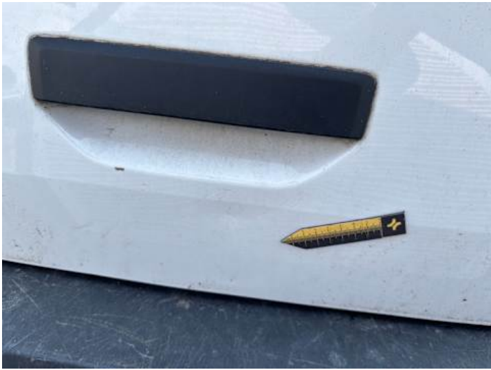
Heckklappe (Delle, Kratzer, Rost)
