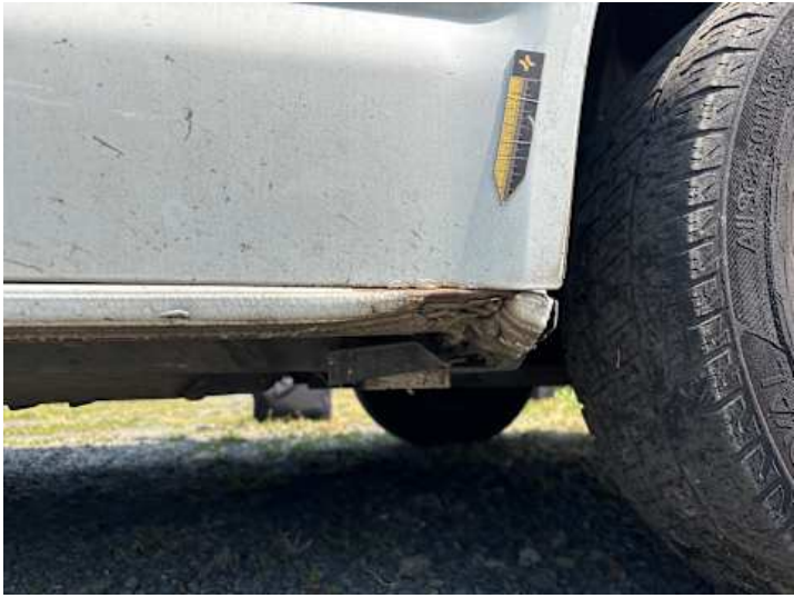
Schweller rechts (Rost, Verformung)
