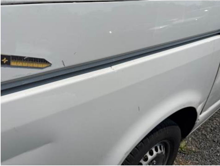
Seitenteil hinten rechts (Verformung, Kratzer, Rost)
