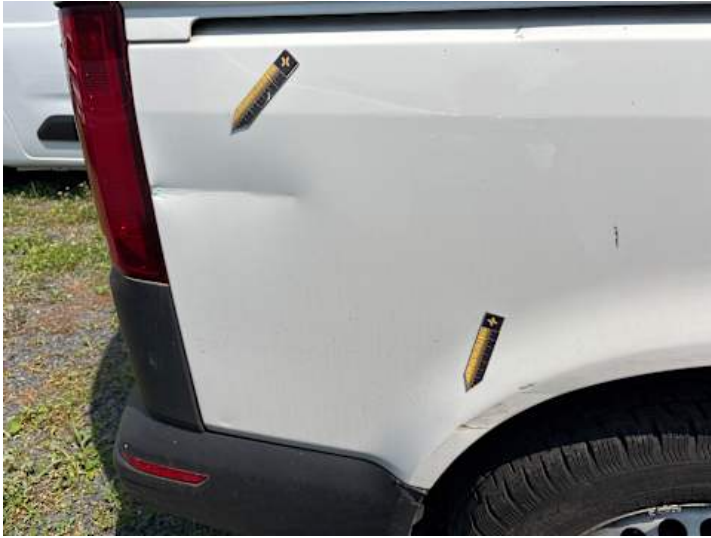
Seitenteil hinten rechts (Verformung, Kratzer, Rost)
