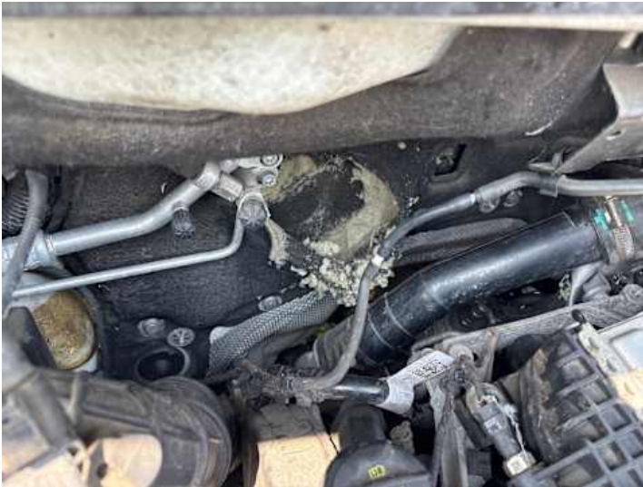
Motorhaube (Riss/Bruch, Anderer Schaden): Tierreste
