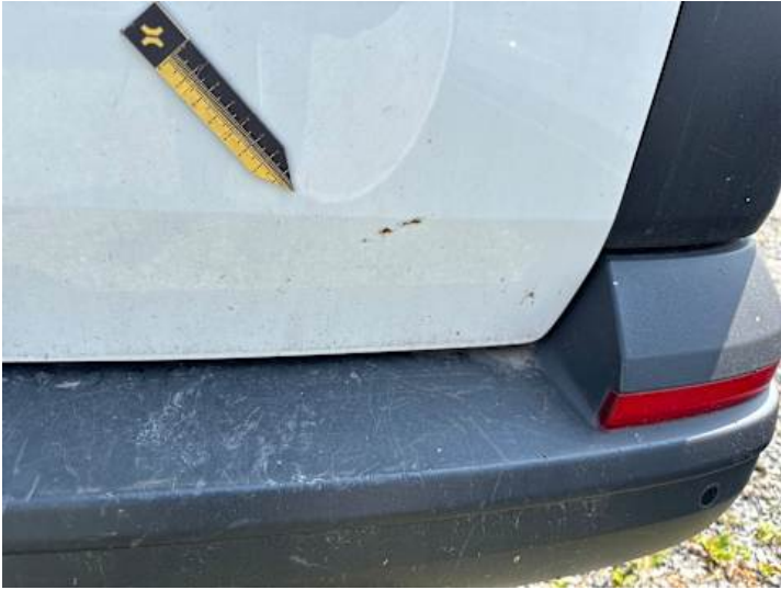
Heckklappe (Delle, Kratzer, Rost)
