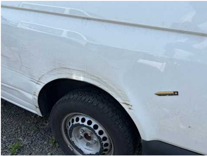
Seitenteil hinten links (Kratzer, Verformung, Rost)
