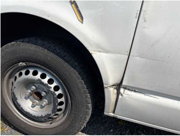
Seitenteil hinten rechts (Verformung, Kratzer, Rost)
