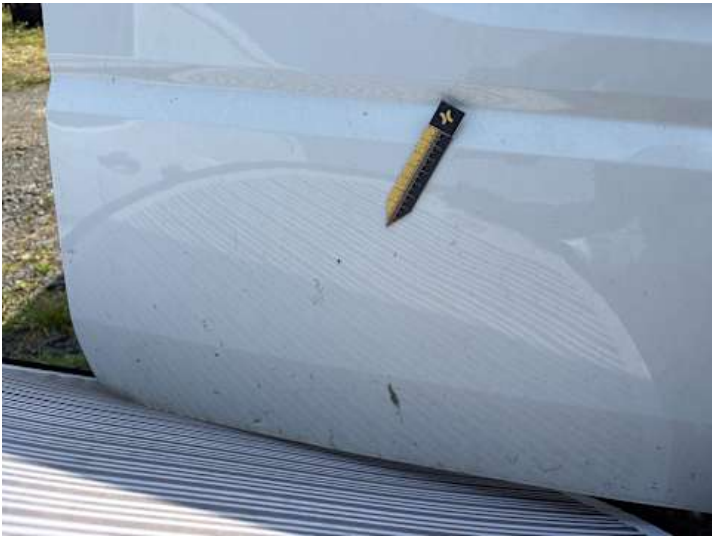
Heckklappe (Delle, Kratzer, Rost)
