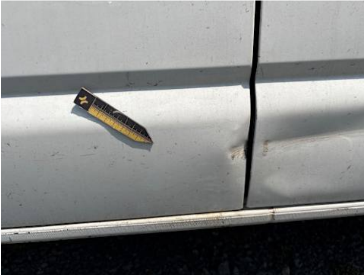
Türe hinten rechts (Verformung, Kratzer)
