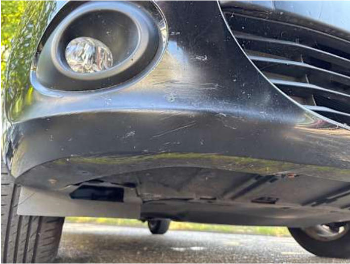
Stoßstange vorne (Kratzer, Unsachgemäß instand gesetzt, Lackschaden)
