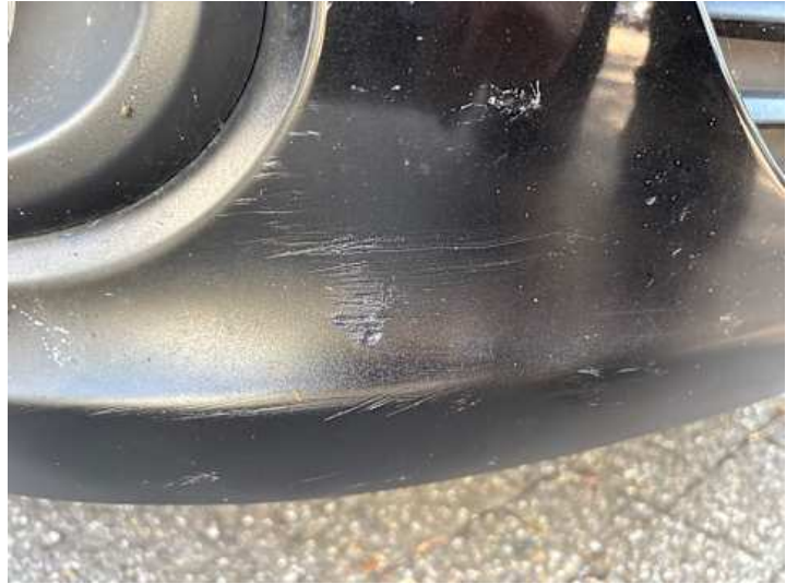
Stoßstange vorne (Kratzer, Unsachgemäß instand gesetzt, Lackschaden)
