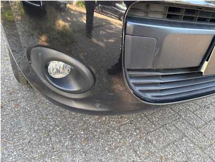
Stoßstange vorne (Kratzer, Unsachgemäß instand gesetzt, Lackschaden)
