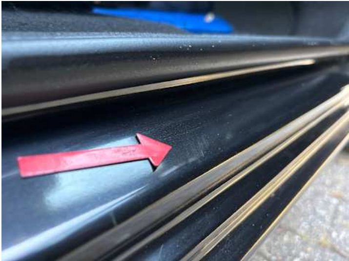
Schweller rechts (Delle)
