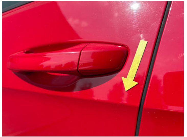
Fahrtür (Lackschaden, Unsachgemäß instand gesetzt)
