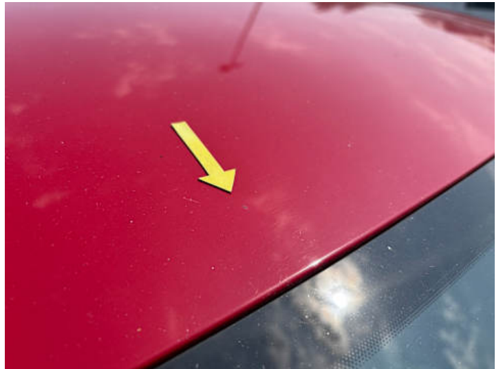
Dach (Rost, Lackschaden)
