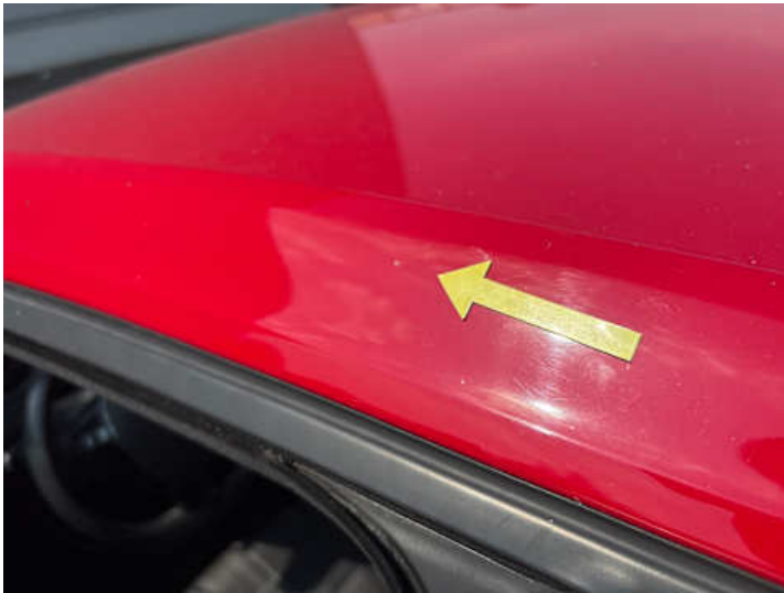
Seitenteil hinten links (Steinschlag)
