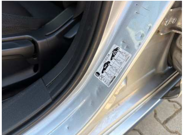
Schweller links (Delle, Kratzer)
