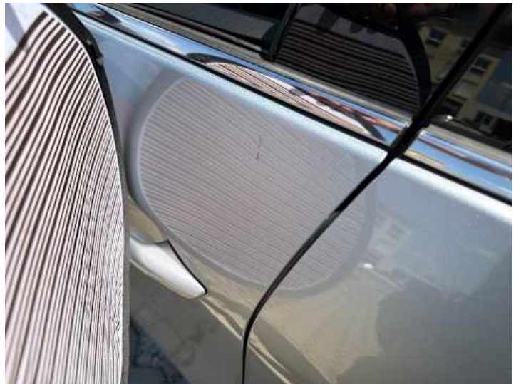
Fahrtür (Delle, Kratzer)
