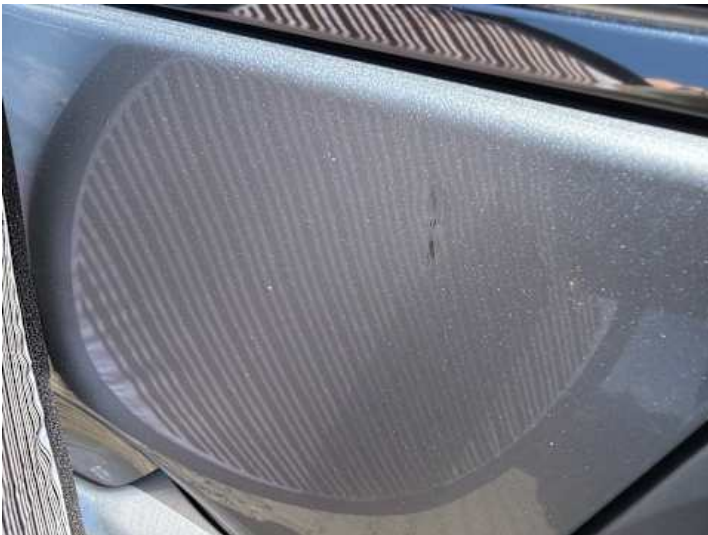
Fahrtür (Delle, Kratzer)
