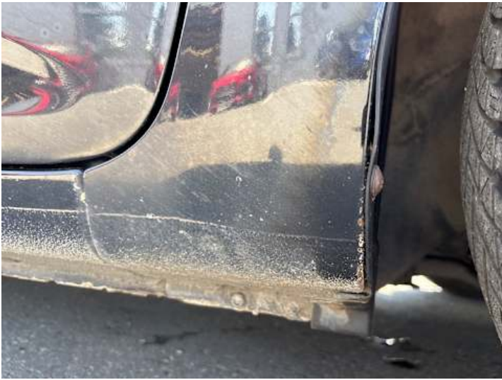
Kotflügel vorne rechts (Rost)
