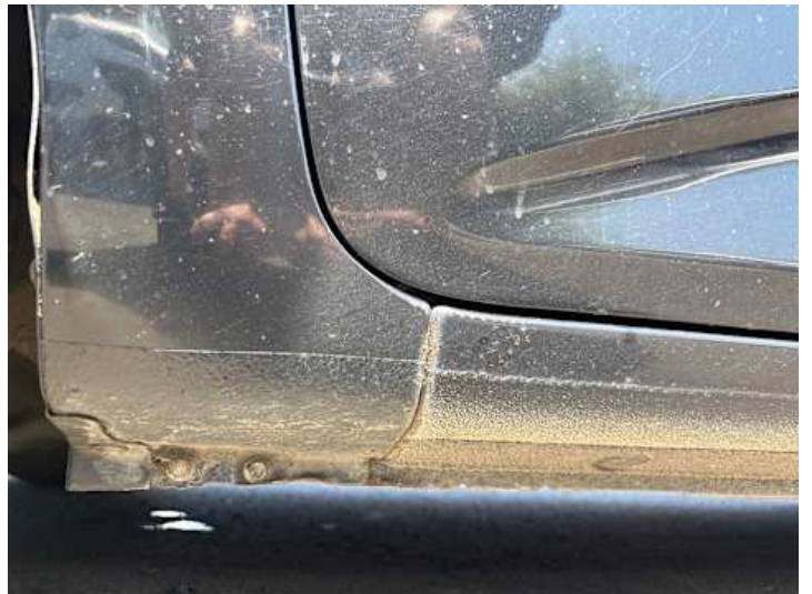
Schweller links (Rost)
