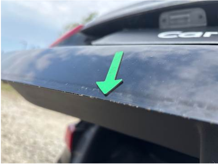
Heckklappe (Kratzer, Rost)
