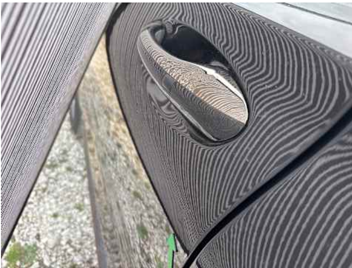
Fahrtür (Delle, Ausgeblichen/Matt, Lackschaden)
