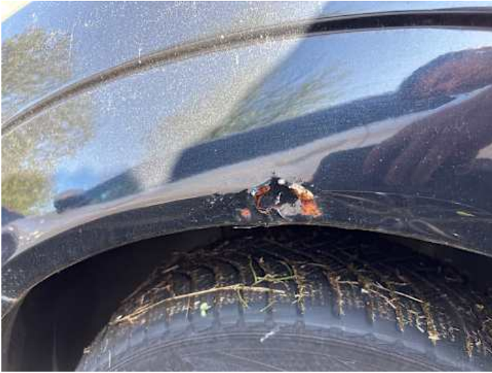
Kotflügel vorne links (Rost)
