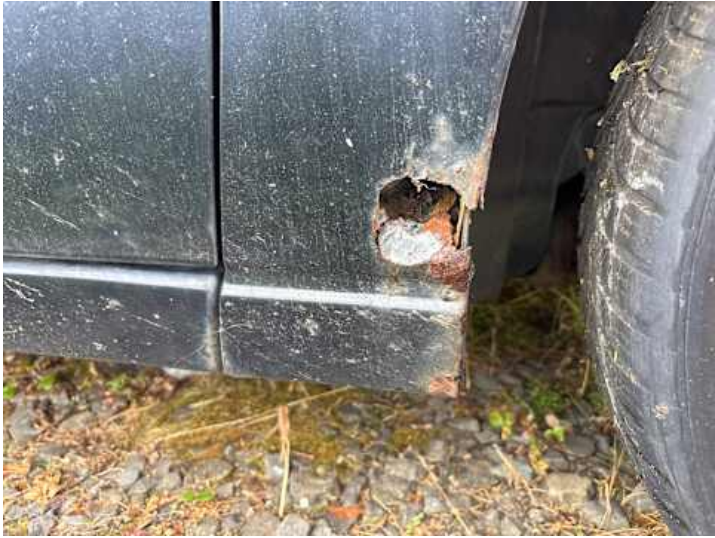
Kotflügel vorne rechts (Rost)
