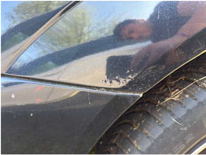
Kotflügel vorne links (Rost)
