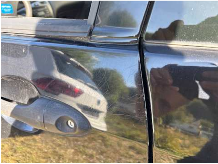
Fahrtür (Kratzer, Rost)
