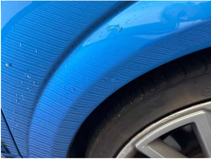
Kotflügel vorne rechts (Delle, Kratzer)
