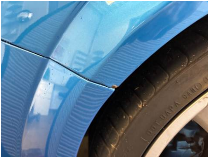
Kotflügel vorne links (Delle, Kratzer, Rost)
