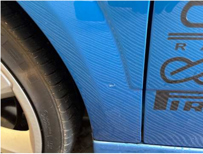
Kotflügel vorne links (Delle, Kratzer, Rost)
