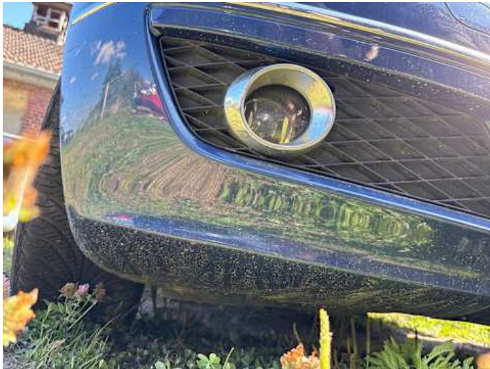
Stoßstange vorne (Kratzer, Lackschaden)
