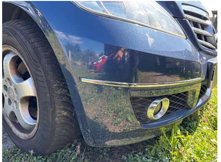
Stoßstange vorne (Kratzer, Lackschaden)
