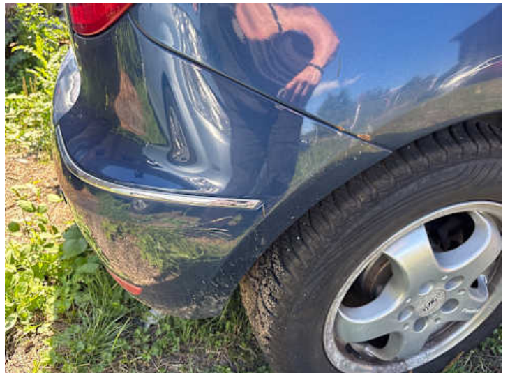
Stoßstange hinten (Kratzer, Lackschaden, Spaltmaße ungenau)
