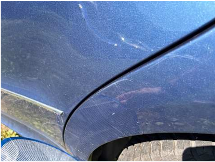
Seitenteil hinten links (Kratzer, Delle)
