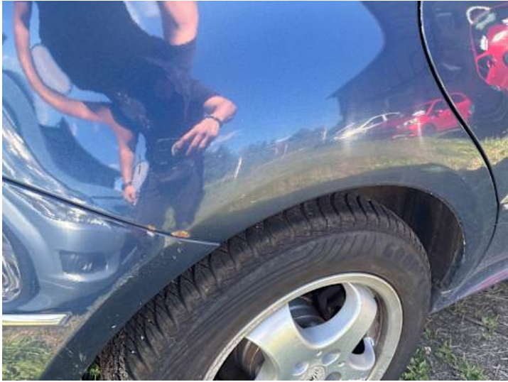
Seitenteil hinten rechts (Lackschaden, Rost, Kratzer)
