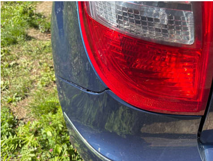
Stoßstange hinten (Kratzer, Lackschaden, Spaltmaße ungenau)
