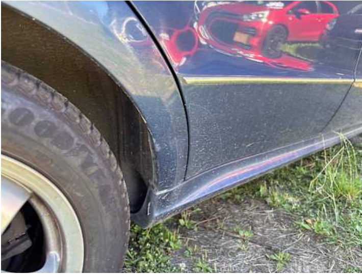
Seitenteil hinten rechts (Lackschaden, Rost, Kratzer)
