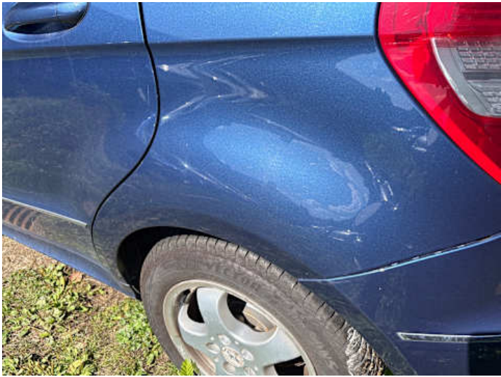
Seitenteil hinten links (Kratzer, Delle)
