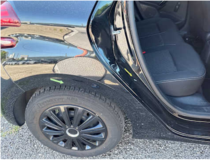
Seitenteil hinten rechts (Delle, Kratzer)
