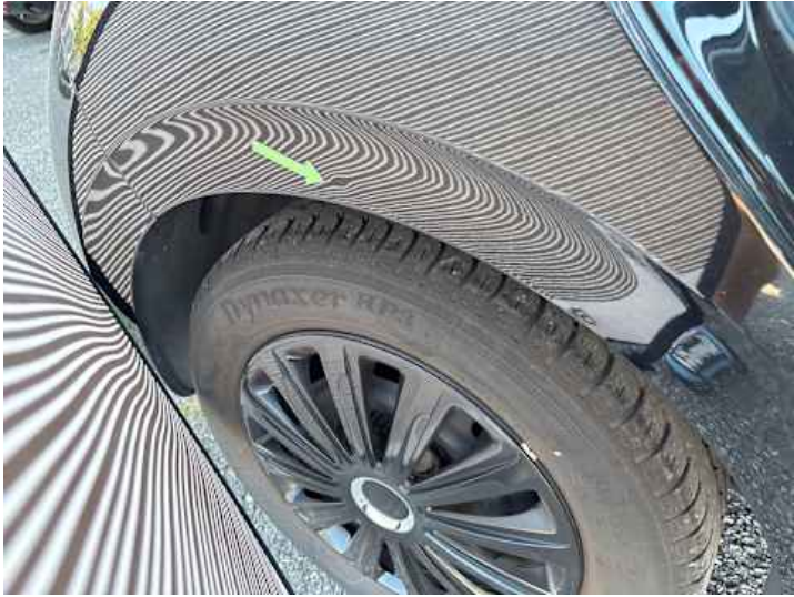
Seitenteil hinten rechts (Delle, Kratzer)
