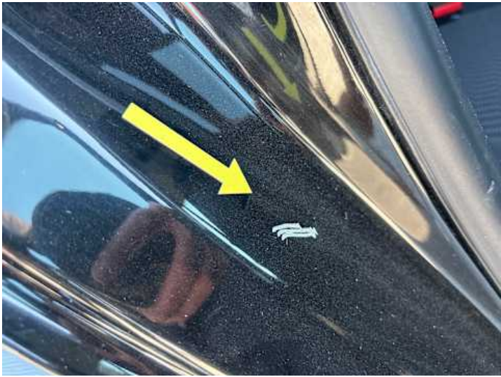
Seitenteil hinten rechts (Delle, Kratzer)
