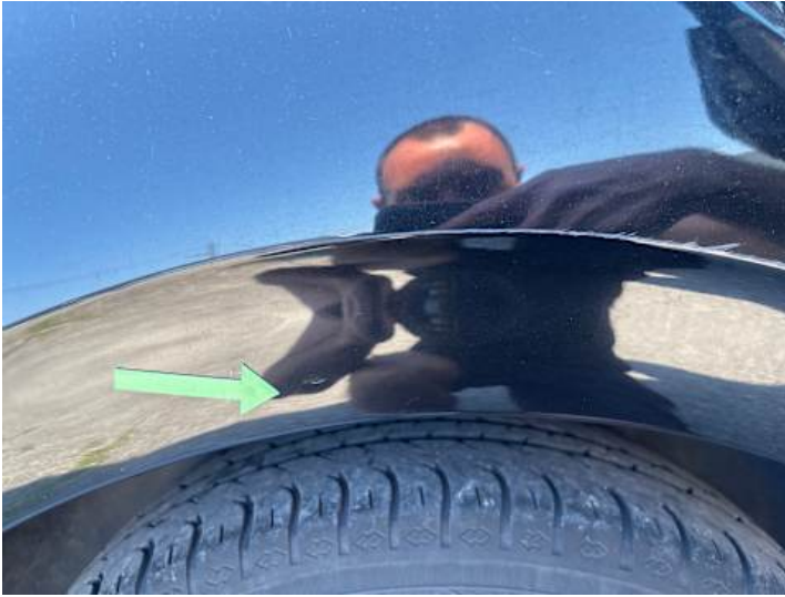
Seitenteil hinten rechts (Delle, Kratzer)
