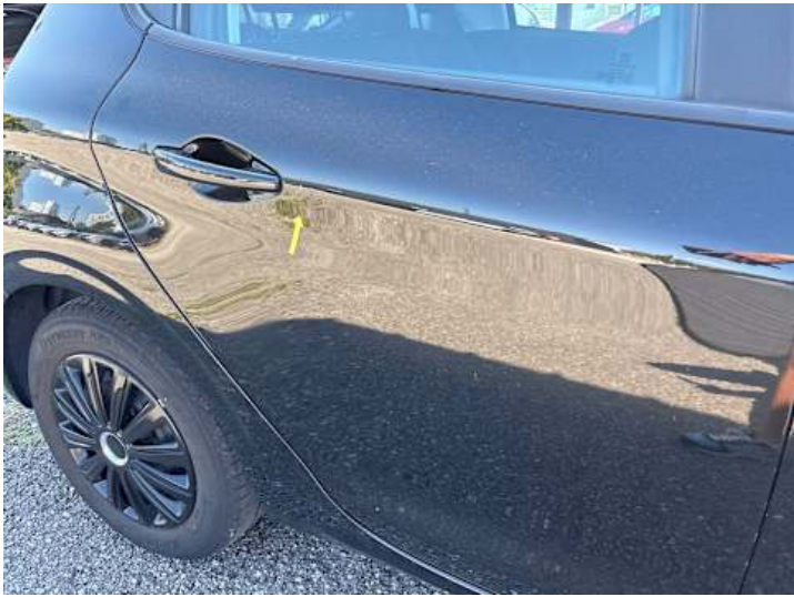
Türe hinten rechts (Delle, Kratzer)
