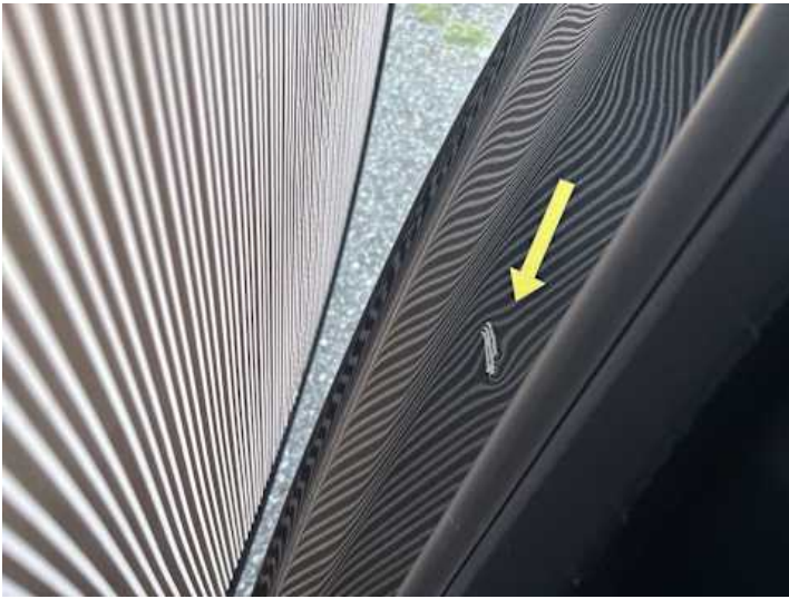
Seitenteil hinten rechts (Delle, Kratzer)
