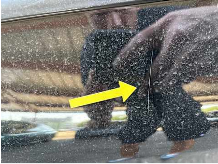
Türe hinten links (Kratzer)
