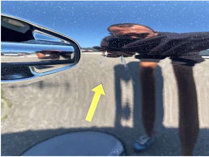
Türe hinten rechts (Delle, Kratzer)
