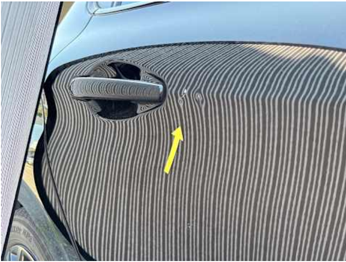
Türe hinten rechts (Delle, Kratzer)
