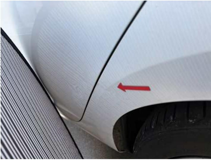
Seitenteil hinten links (Verformung)
