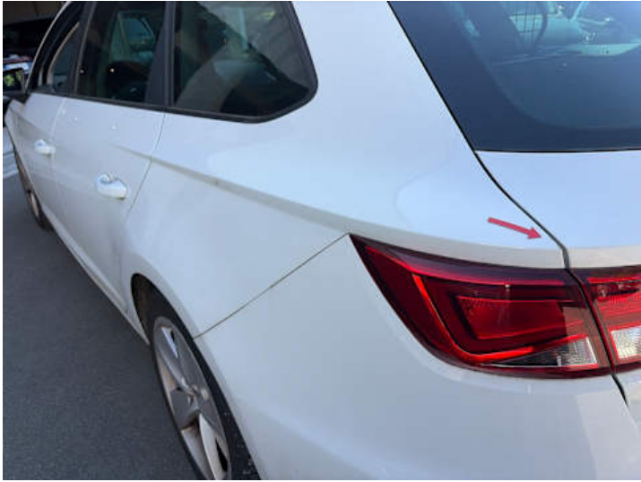
Seitenteil hinten links (Rost)
