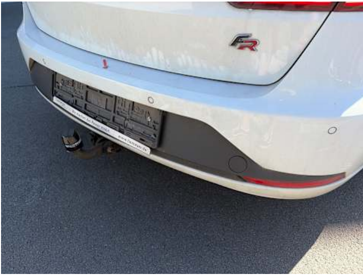
Stoßstange hinten (Verformung, Riss/Bruch)
