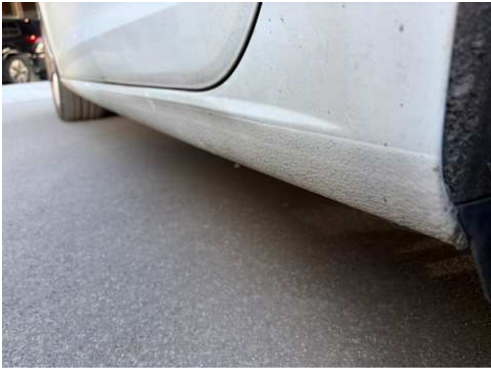
Schweller links (Verformung)
