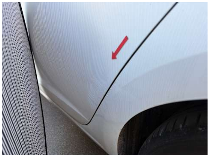
Türe hinten links (Verformung)
