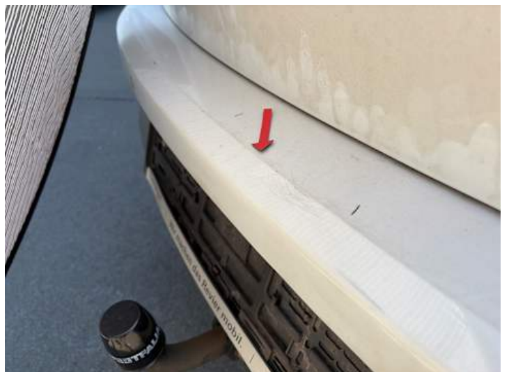
Stoßstange hinten (Verformung, Riss/Bruch)
