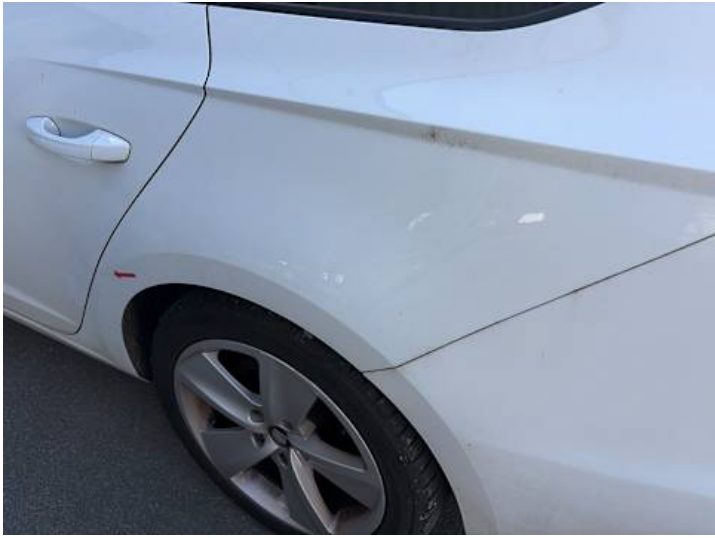
Seitenteil hinten links (Verformung)
