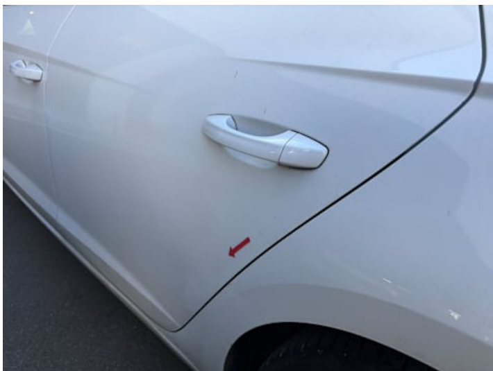
Türe hinten links (Verformung)
