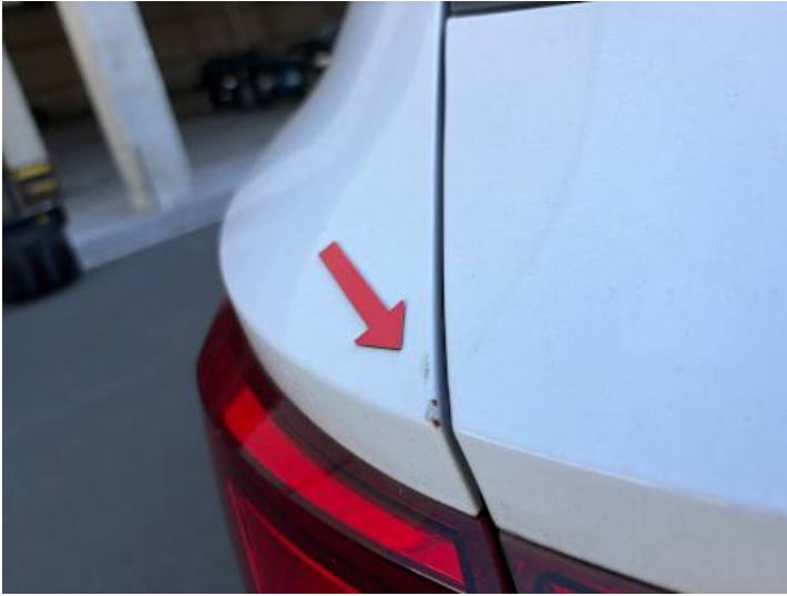
Seitenteil hinten links (Rost)
