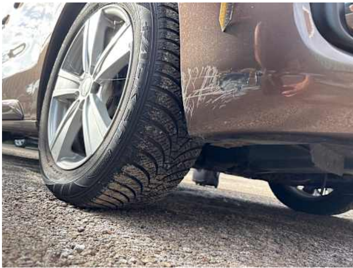
Stoßstange vorne (Kratzer, Unsachgemäß instand gesetzt)
