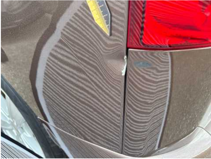
Seitenteil hinten links (Kratzer, Delle)
