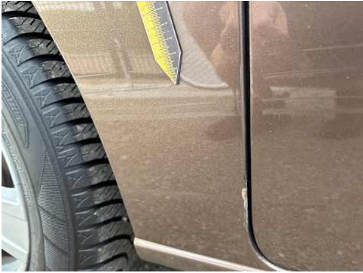
Seitenteil hinten rechts (Kratzer, Rost)
