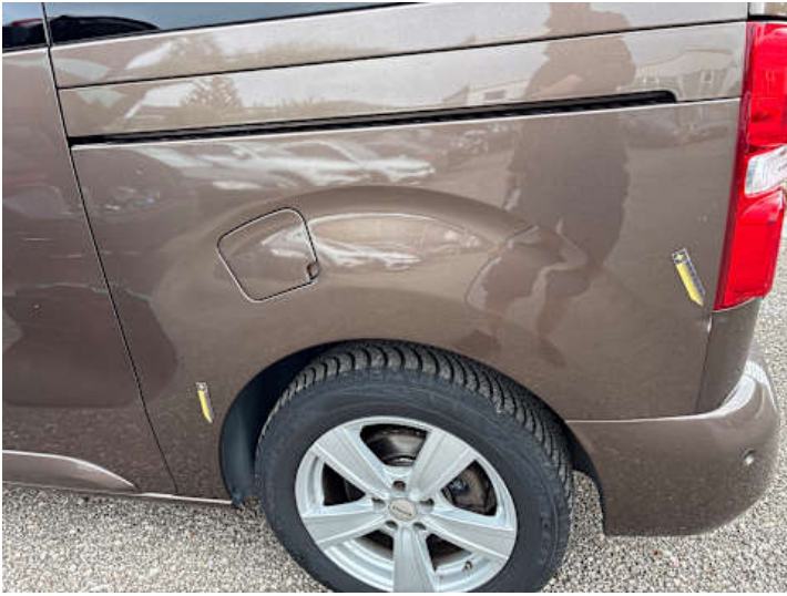
Seitenteil hinten links (Kratzer, Delle)
