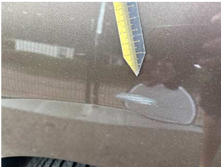
Seitenteil hinten rechts (Kratzer)
