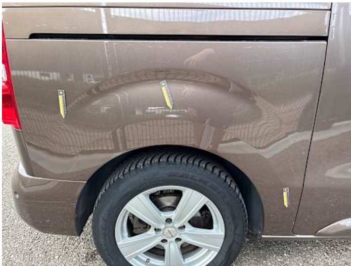
Seitenteil hinten rechts (Kratzer, Rost)
