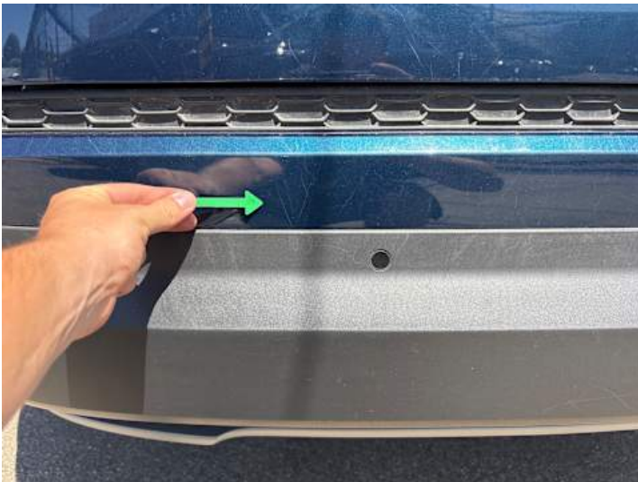
Stoßstange hinten (Kratzer, Lackschaden)
