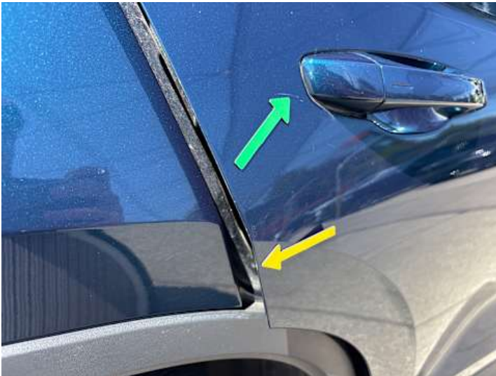
Türe hinten rechts (Kratzer, Lackschaden)
