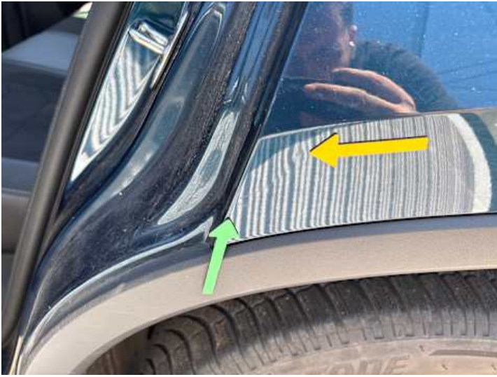
Seitenteil hinten links (Kratzer, Lackschaden, Delle)
