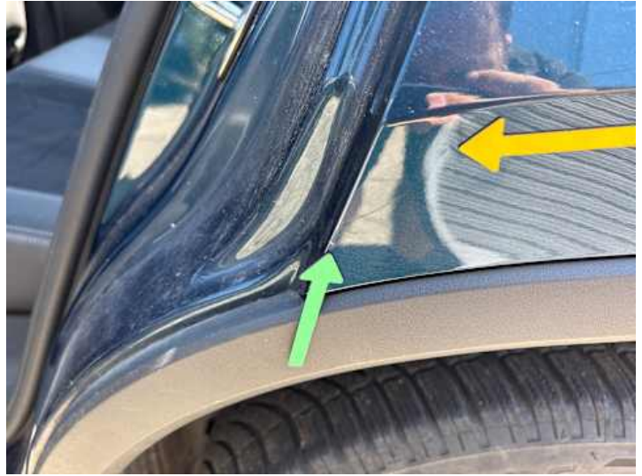
Seitenteil hinten links (Kratzer, Lackschaden, Delle)
