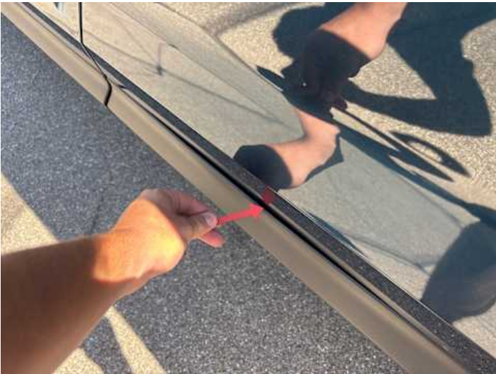
Türe hinten links (Spaltmaße ungenau)
