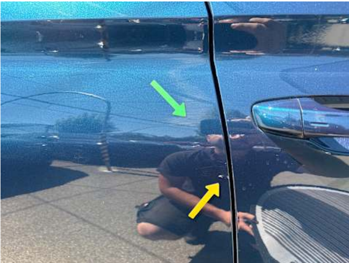
Türe hinten rechts (Kratzer, Lackschaden)
