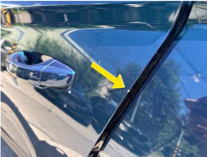
Türe hinten links (Lackschaden)
