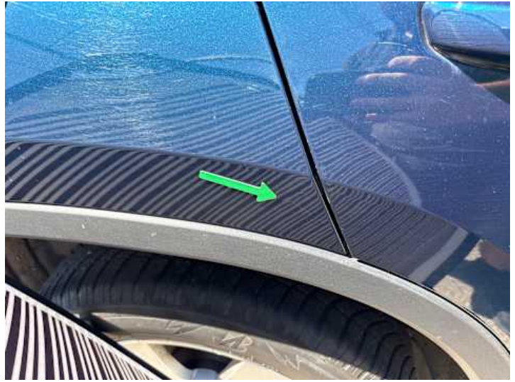
Seitenteil hinten rechts (Delle)
