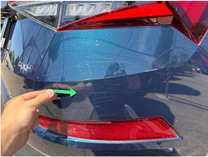
Stoßstange hinten (Kratzer, Lackschaden)
