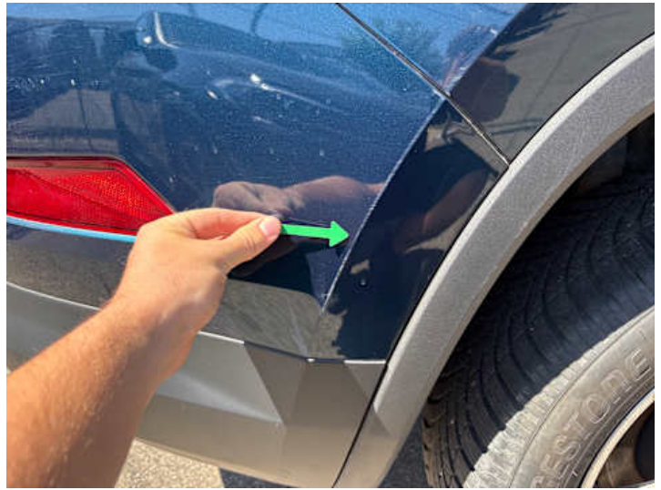
Stoßstange hinten (Kratzer, Lackschaden)
