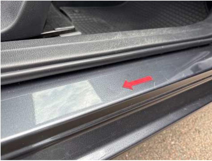
Schweller rechts (Delle)
