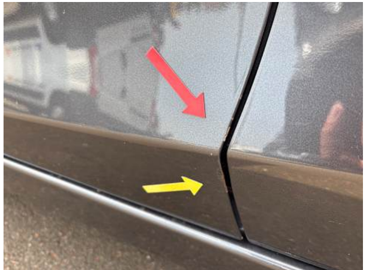
Fahrtür (Lackschaden, Rost)
