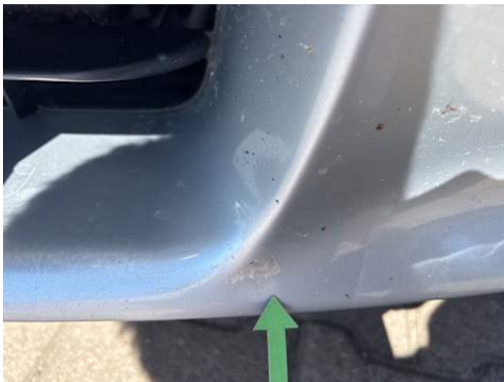
Stoßstange vorne (Lackschaden, Unsachgemäß instand gesetzt)
