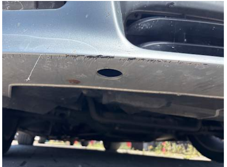
Stoßstange vorne (Lackschaden, Unsachgemäß instand gesetzt)
