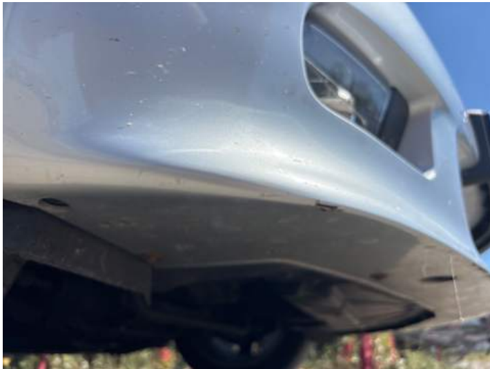
Stoßstange vorne (Lackschaden, Unsachgemäß instand gesetzt)
