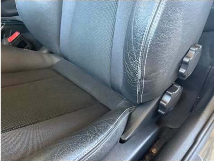
Innenraum (Verschmutzung, Verschleiß)
