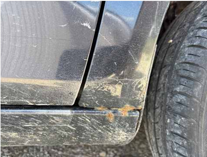
Kotflügel vorne rechts (Lackschaden, Rost)
