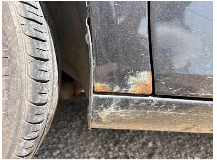
Kotflügel vorne links (Lackschaden, Rost)
