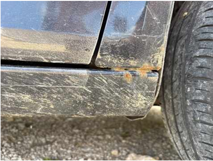
Schweller rechts (Lackschaden, Rost, Verformung)
