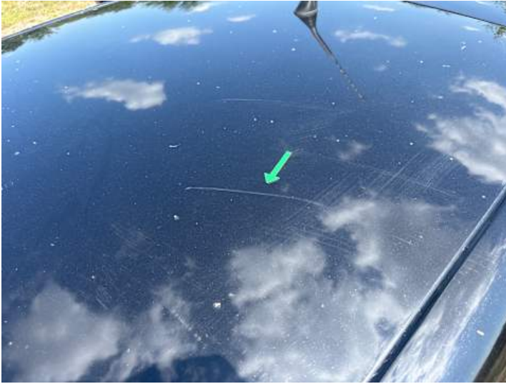
Dach (Kratzer, Lackschaden)
