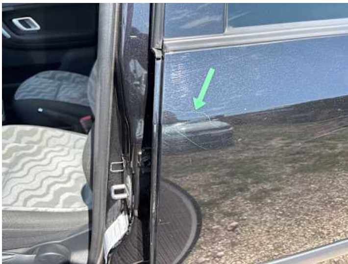
Türe hinten links (Kratzer, Lackschaden, Rost)
