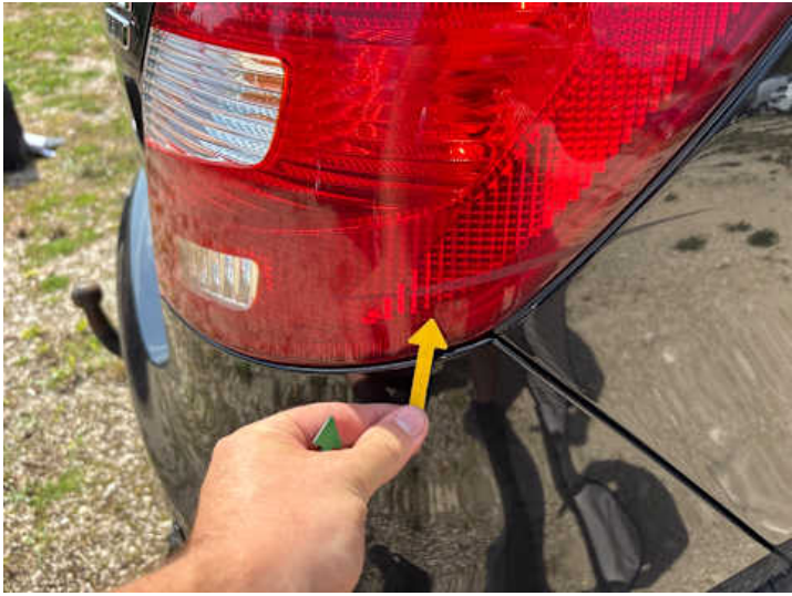
Rücklicht (rechts) (Kratzer)
