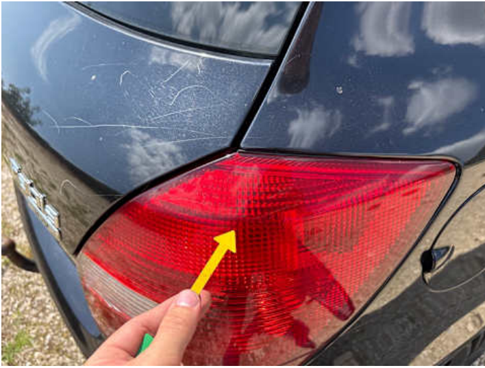
Rücklicht (rechts) (Kratzer)
