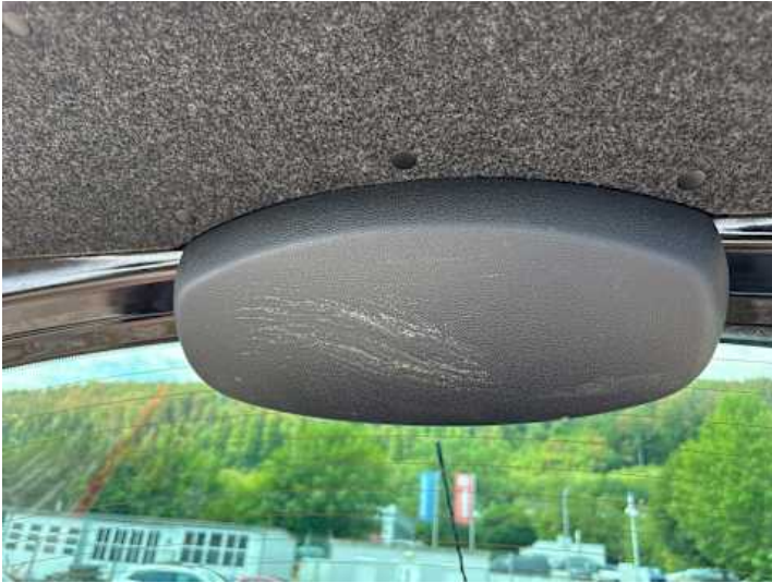
Innenraum (Verschmutzung, Verschleiß)
