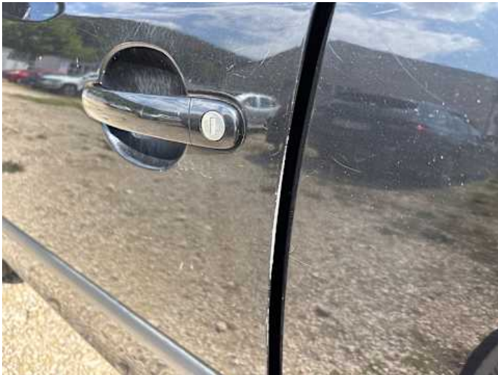
Fahrtür (Lackschaden, Rost, Kratzer)
