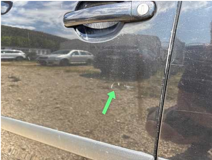
Fahrtür (Lackschaden, Rost, Kratzer)
