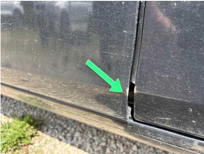
Fahrtür (Lackschaden, Rost, Kratzer)
