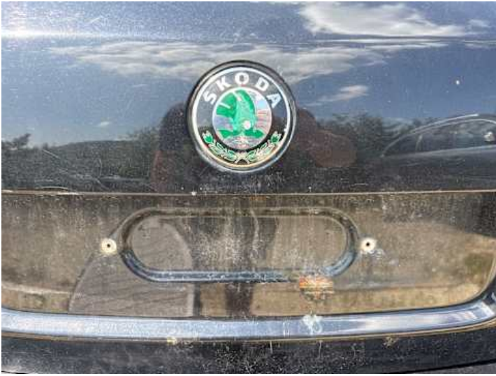
Heckklappe (Lackschaden, Kratzer, Rost)
