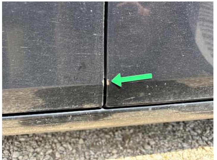
Türe hinten links (Kratzer, Lackschaden, Rost)
