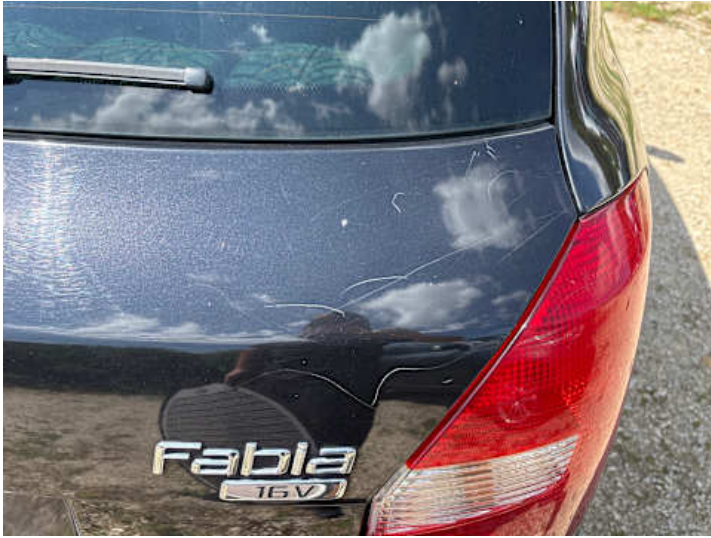
Heckklappe (Lackschaden, Kratzer, Rost)
