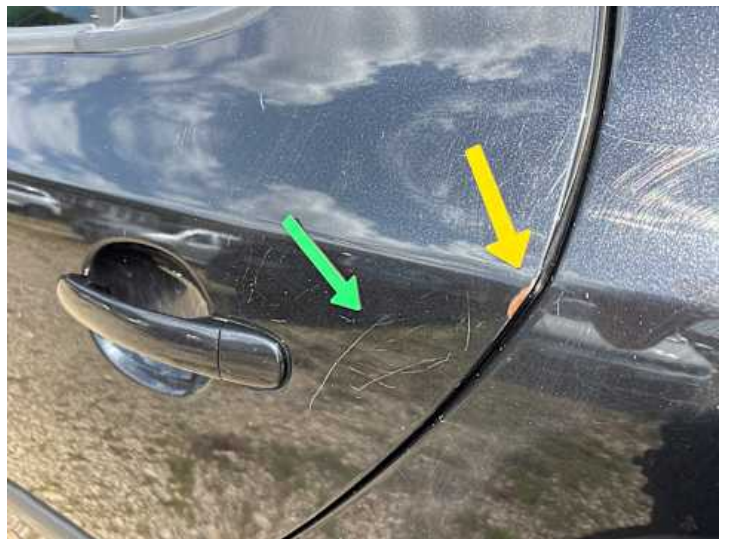
Türe hinten links (Kratzer, Lackschaden, Rost)
