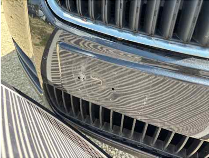
Stoßstange vorne (Verformung)
