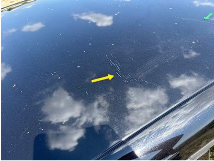
Dach (Kratzer, Lackschaden)
