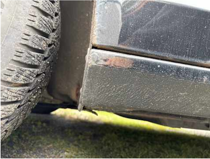
Schweller links (Rost)
