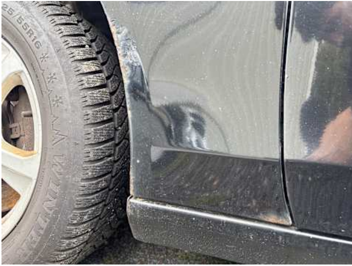
Kotflügel vorne links (Rost)
