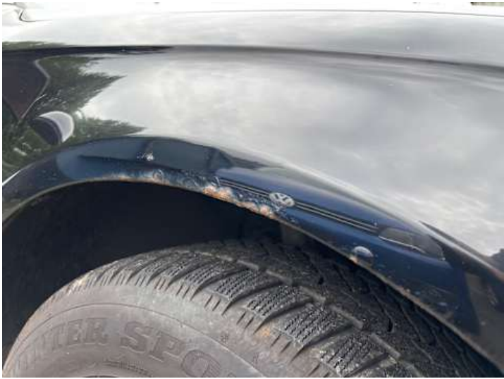
Kotflügel vorne rechts (Rost)
