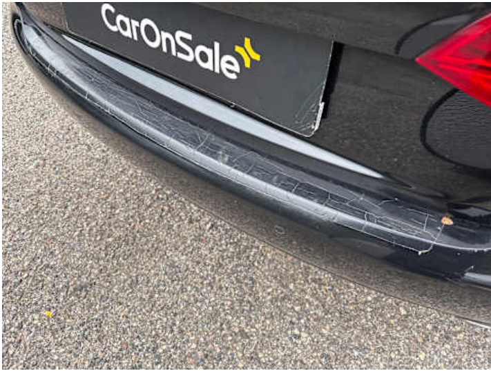
Stoßstange hinten (Lackschaden)
