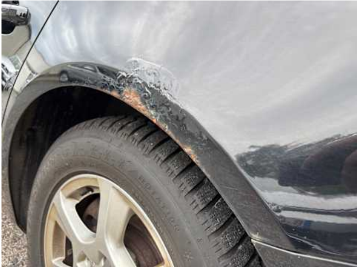
Seitenteil hinten links (Rost)
