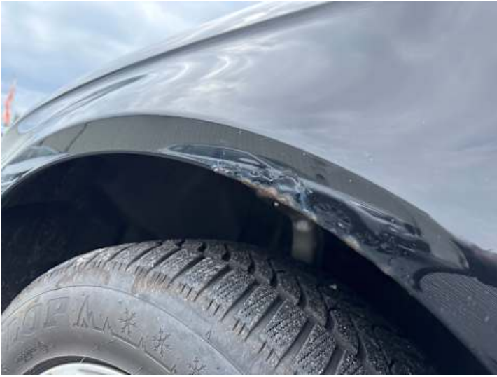
Kotflügel vorne links (Rost)
