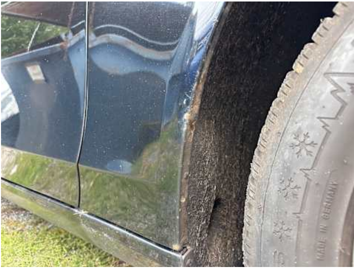
Kotflügel vorne rechts (Rost)
