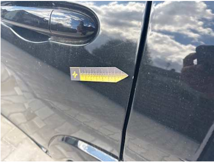
Türe hinten links (Lackschaden)
