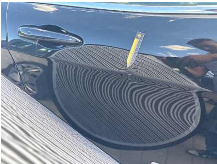
Beifahrertür (Verformung, Lackschaden)
