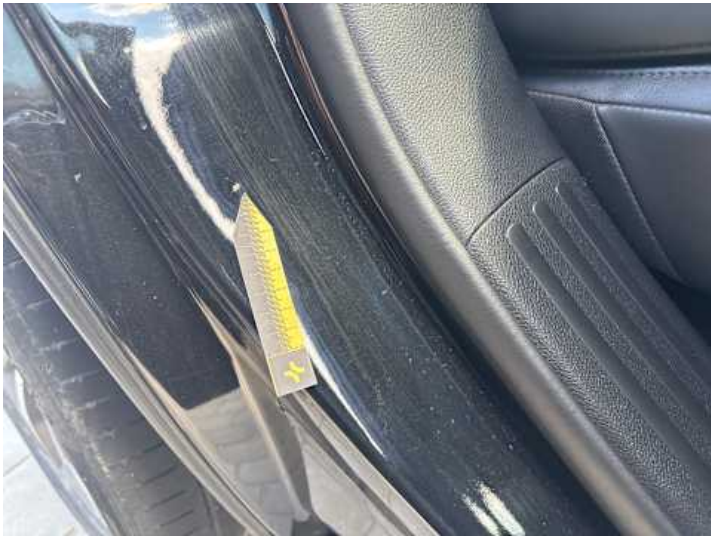
Türe hinten rechts (Lackschaden)
