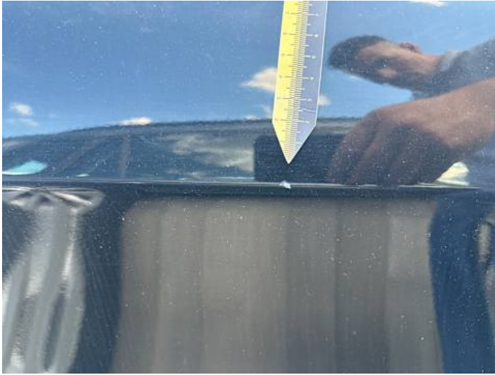
Türe hinten rechts (Lackschaden)
