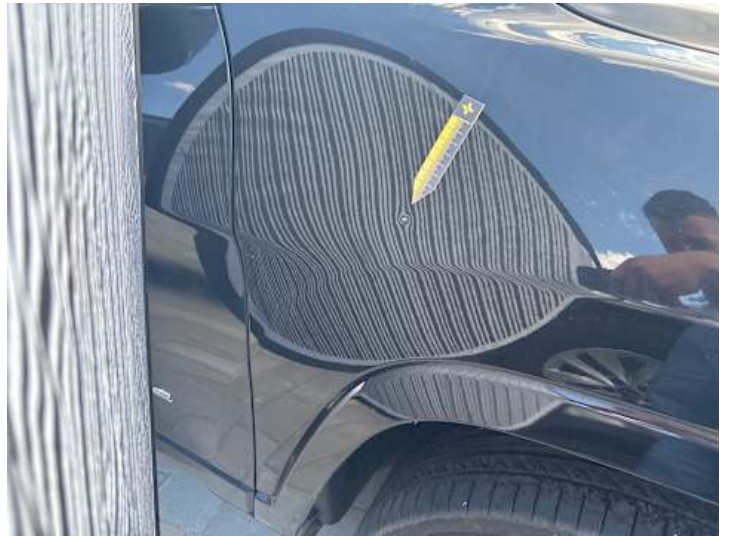
Motorhaube (Delle, Lackschaden)
