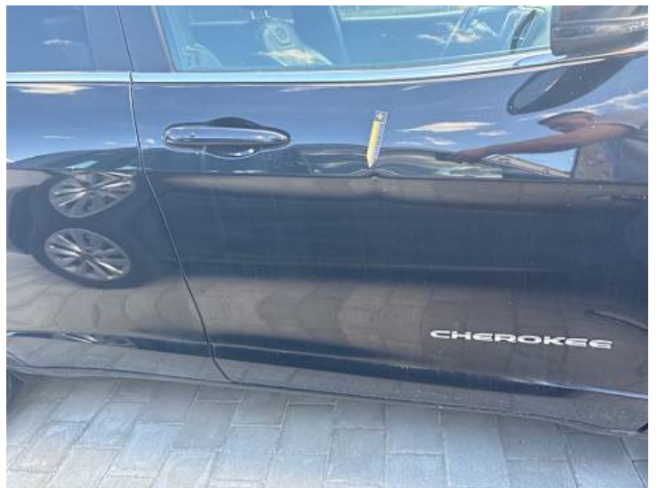
Beifahrertür (Verformung, Lackschaden)
