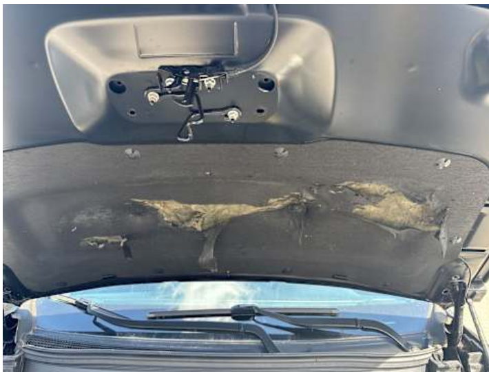
Motorhaube (Anderer Schaden): Marderspuren
