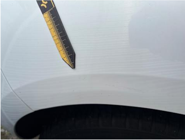
Seitenteil hinten rechts (Verformung)
