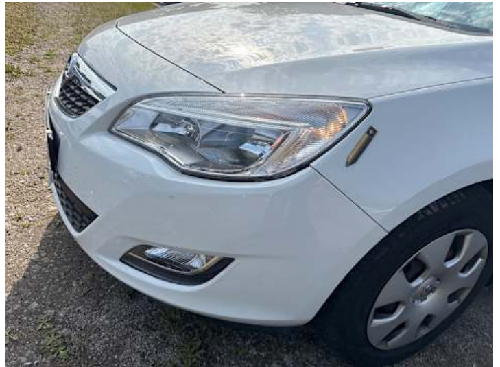
Stoßstange vorne (Spaltmaße ungenau)
