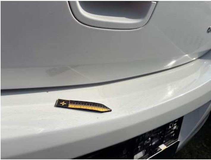
Stoßstange hinten (Kratzer)
