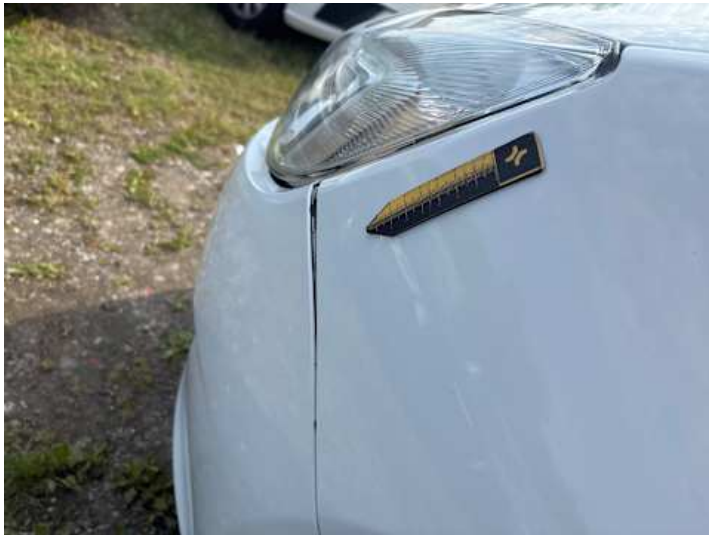
Stoßstange vorne (Spaltmaße ungenau)
