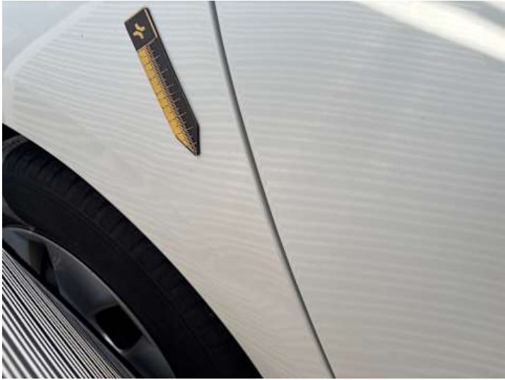
Seitenteil hinten rechts (Verformung)
