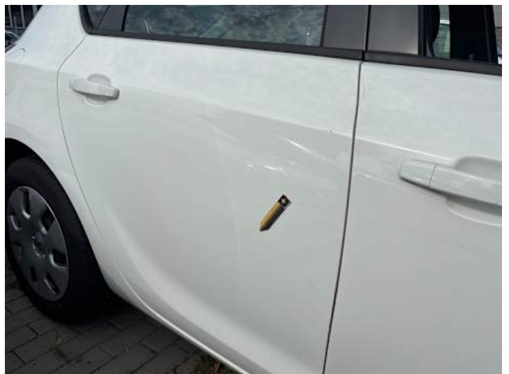
Türe hinten rechts (Verformung)
