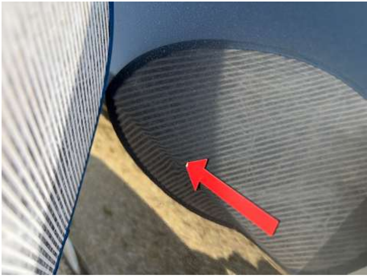
Türe hinten rechts (Delle)
