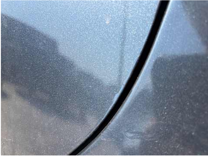
Türe hinten links (Lackschaden)
