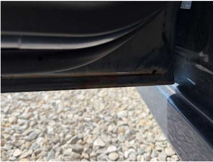
Türe hinten links (Rost)
