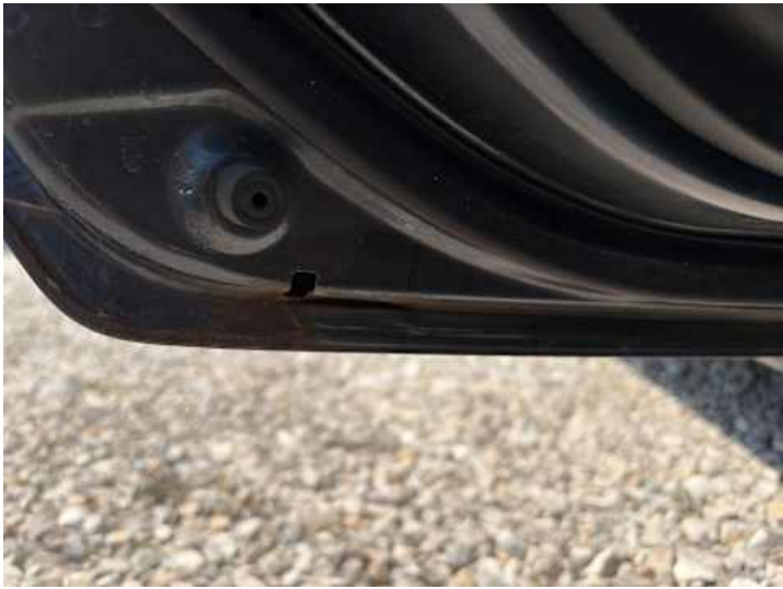
Türe hinten links (Rost)
