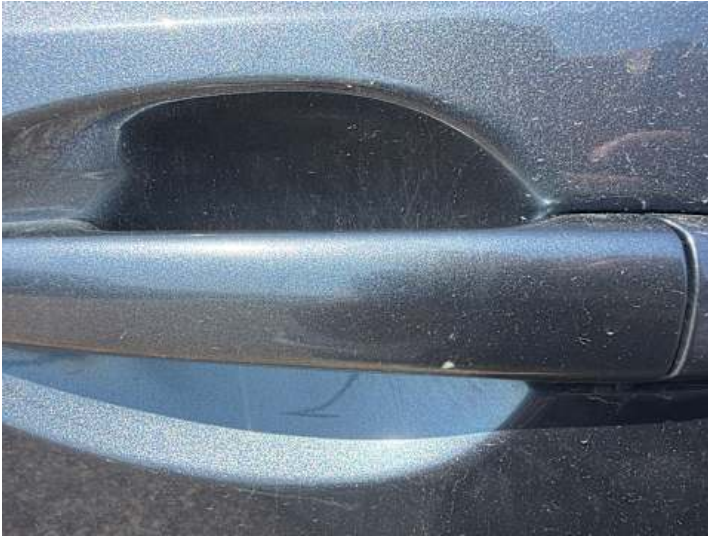
Türe hinten links (Lackschaden)
