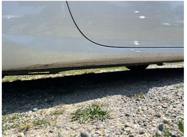
Schweller rechts (Verformung, Kratzer)
