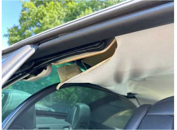
Innenraum (Anderer Schaden): Dachhimmel hängt durch
