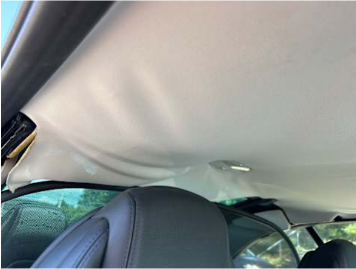
Innenraum (Anderer Schaden): Dachhimmel hängt durch
