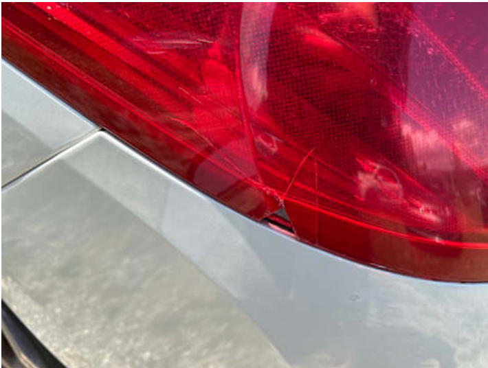
Rücklicht (links) (Riss/Bruch)
