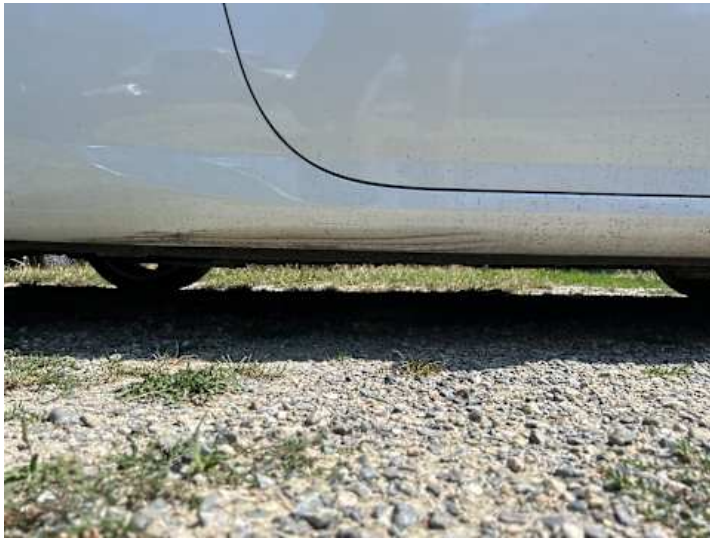
Schweller rechts (Verformung, Kratzer)
