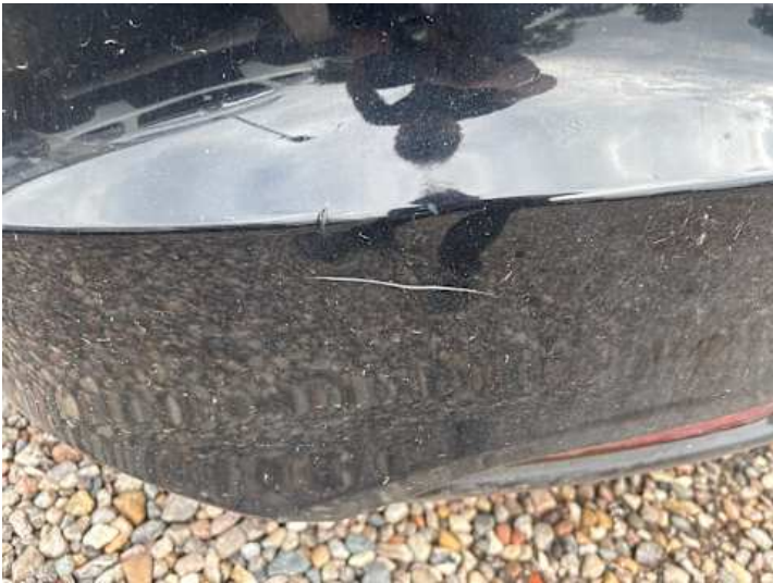
Stoßstange hinten (Lackschaden, Kratzer)
