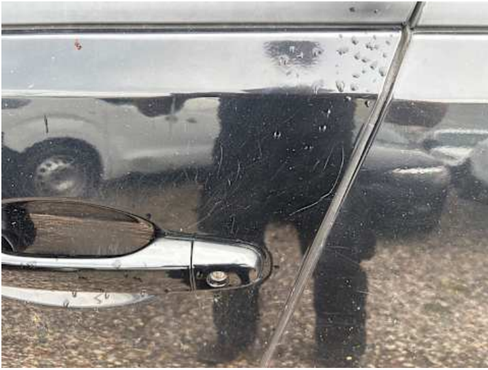
Fahrentür (Kratzer, Lackschaden)
