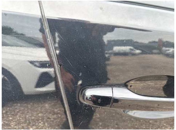
Beifahrertür (Kratzer, Lackschaden)
