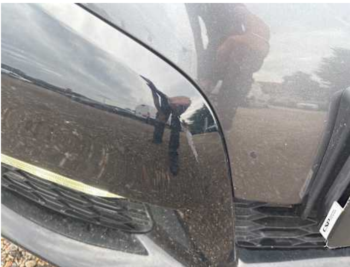
Stoßstange vorne (Lackschaden, Kratzer)
