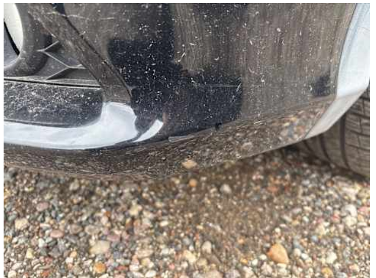
Stoßstange vorne (Lackschaden, Kratzer)
