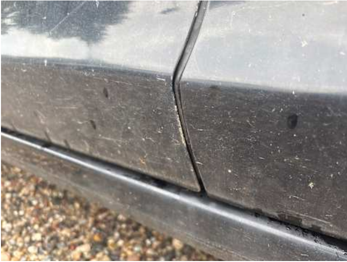
Fahrentür (Kratzer, Lackschaden)
