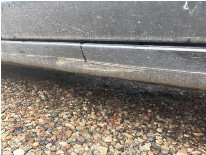
Schweller links (Lackschaden, Delle, Verformung, Kratzer)
