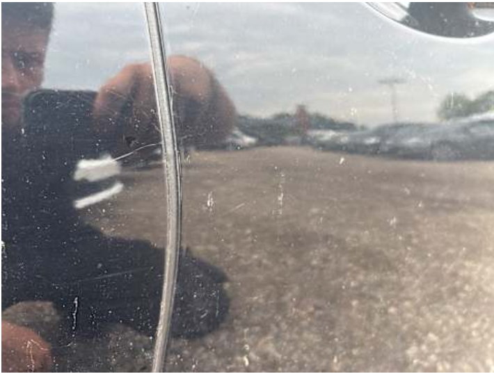
Beifahrertür (Kratzer, Lackschaden)
