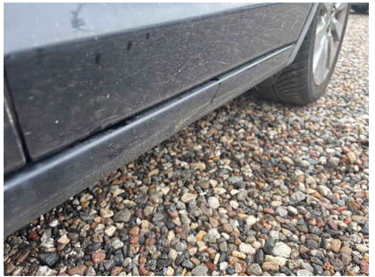
Schweller links (Lackschaden, Delle, Verformung, Kratzer)
