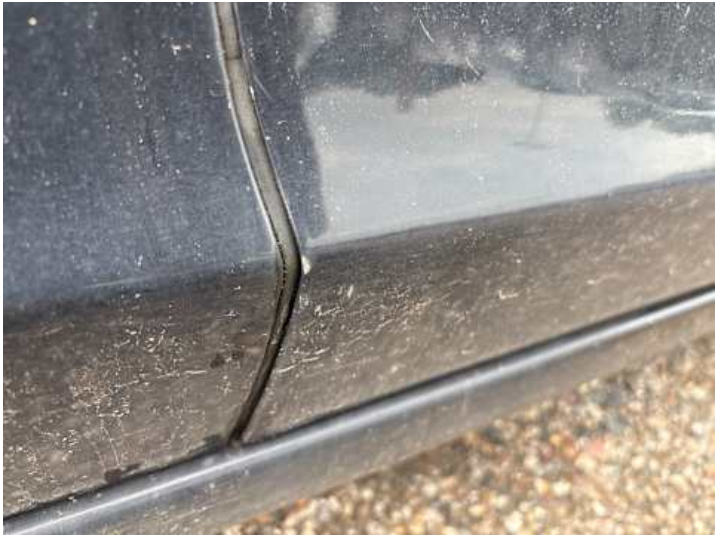
Beifahrentür (Kratzer, Lackschaden)
