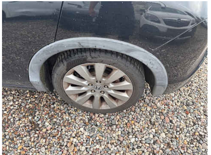
Seitenteil hinten links (Lackschaden, Kratzer, Ausgeblichen/Matt)
