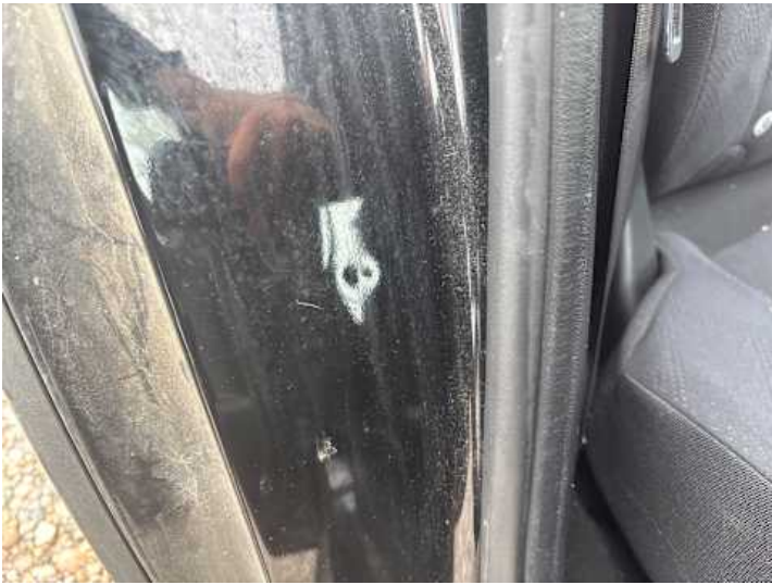
Seitenteil hinten rechts (Kratzer, Delle)
