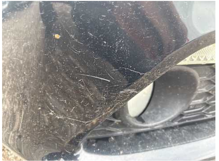
Stoßstange vorne (Lackschaden, Kratzer)
