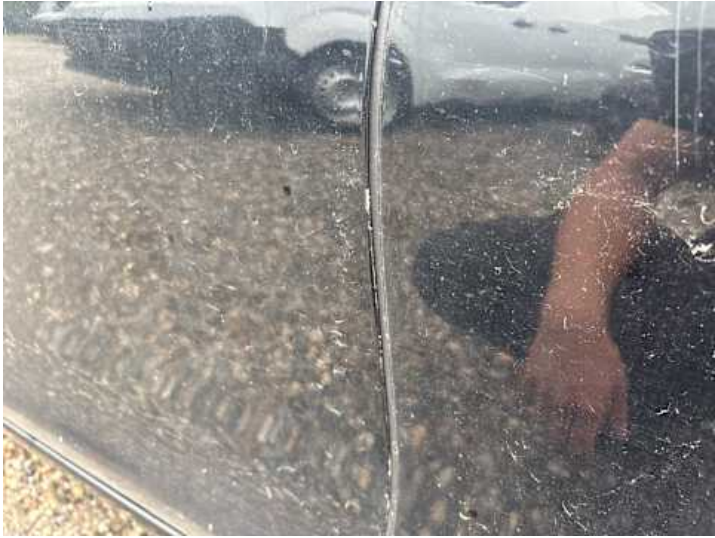
Fahrentür (Kratzer, Lackschaden)
