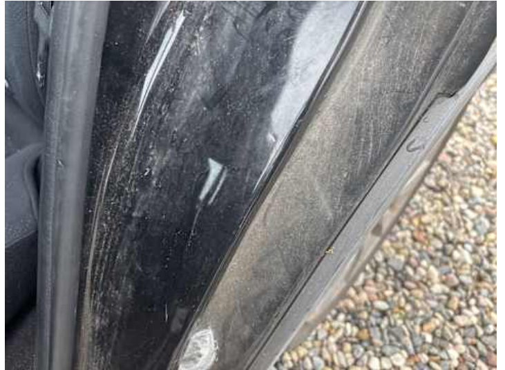
Seitenteil hinten links (Lackschaden, Delle, Kratzer)
