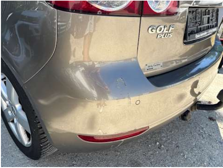
Stoßstange hinten (Riss/Bruch, Verformung, Kratzer, Lackschaden)
