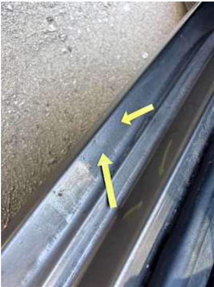
Schweller links (Rost, Lackschaden, Anderer Schaden): Gummi Dichtung
