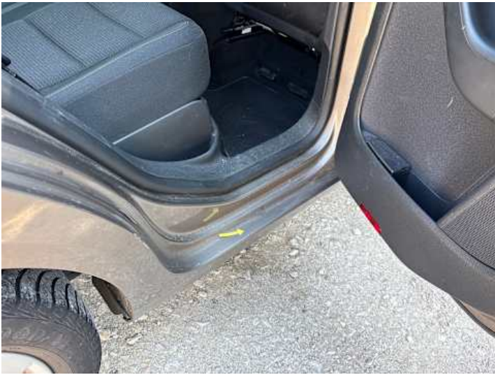
Schweller rechts (Rost)
