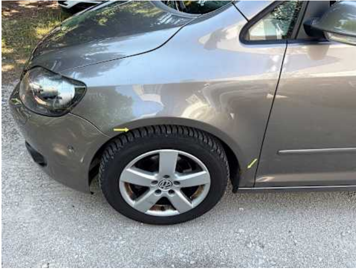
Kotflügel vorne links (Rost, Lackschaden)
