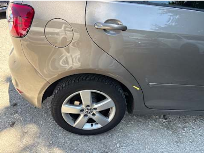
Seitenteil hinten rechts (Lackschaden)
