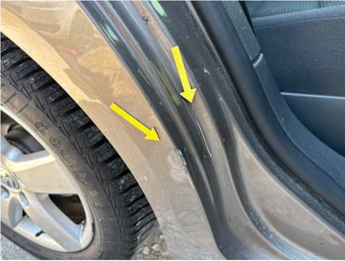
Seitenteil hinten rechts (Lackschaden)
