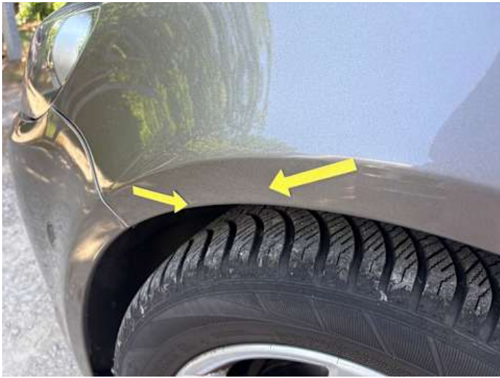
Kotflügel vorne links (Rost, Lackschaden)
