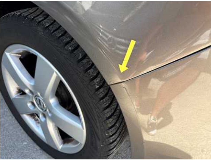
Seitenteil hinten links (Unsachgemäß instand gesetzt, Rost)
