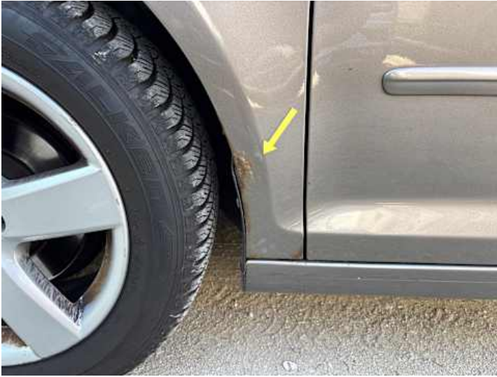
Kotflügel vorne links (Rost, Lackschaden)
