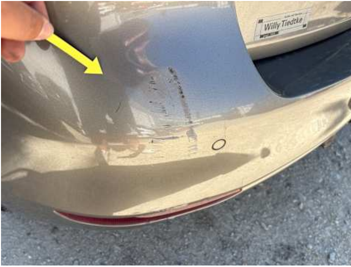
Stoßstange hinten (Riss/Bruch, Verformung, Kratzer, Lackschaden)
