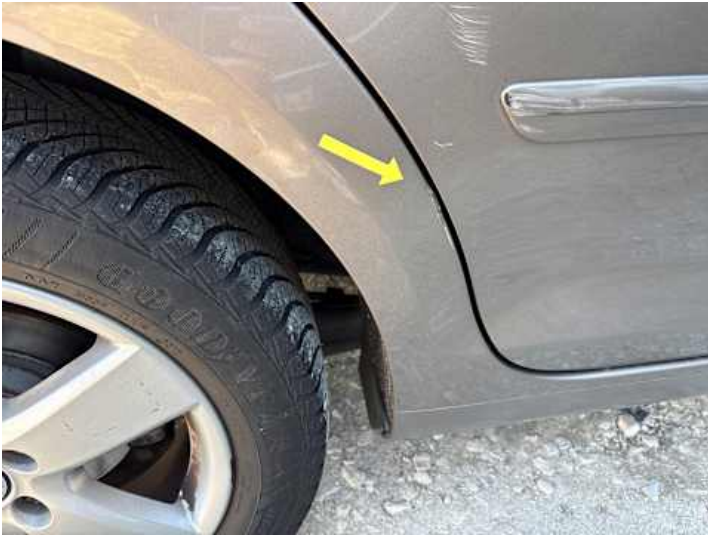
Seitenteil hinten rechts (Lackschaden)
