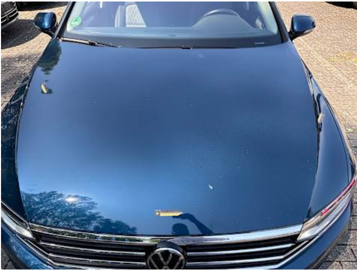
Motorhaube (Unsachgemäß instand gesetzt)
