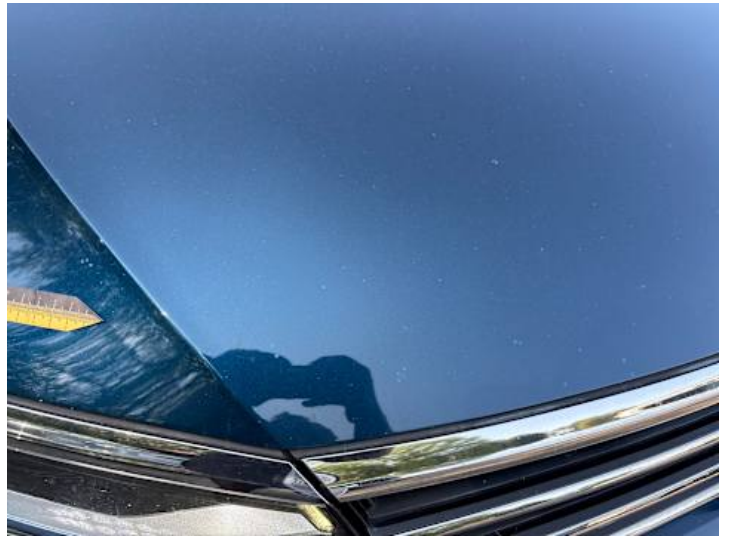
Motorhaube (Unsachgemäß instand gesetzt)
