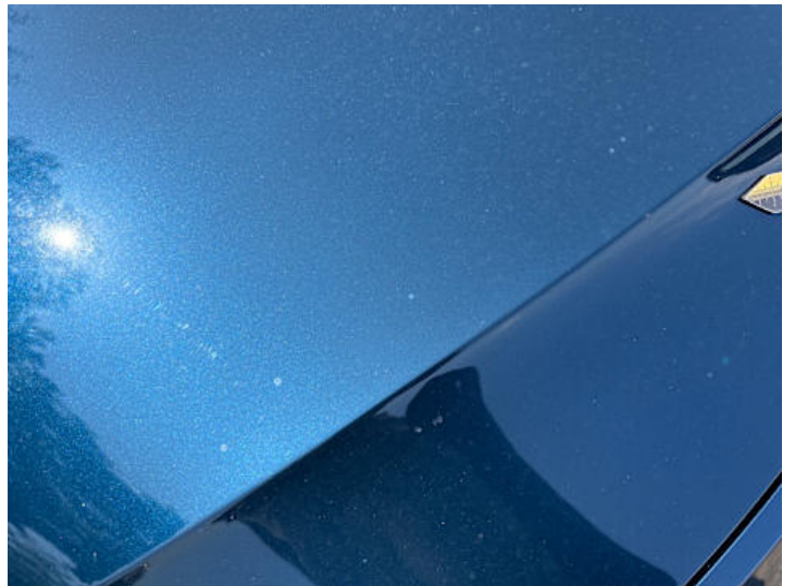
Motorhaube (Unsachgemäß instand gesetzt)
