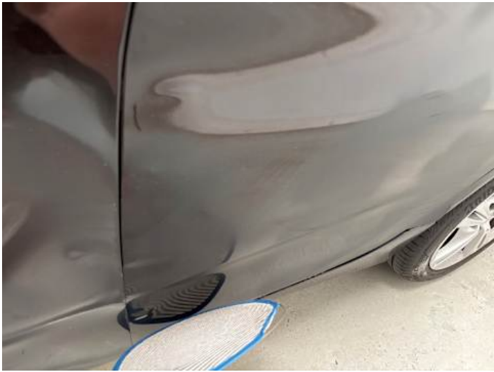
Türe hinten links (Lackschaden, Kratzer, Verformung)
