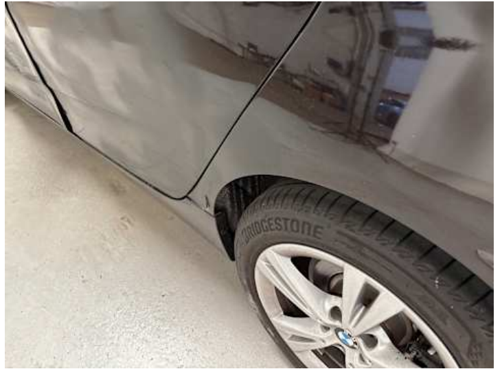
Seitenteil hinten links (Lackschaden, Kratzer, Riss/Bruch)
