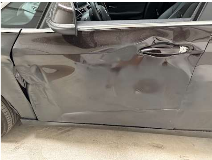
Fahrertür (Lackschaden, Verformung, Kratzer)
