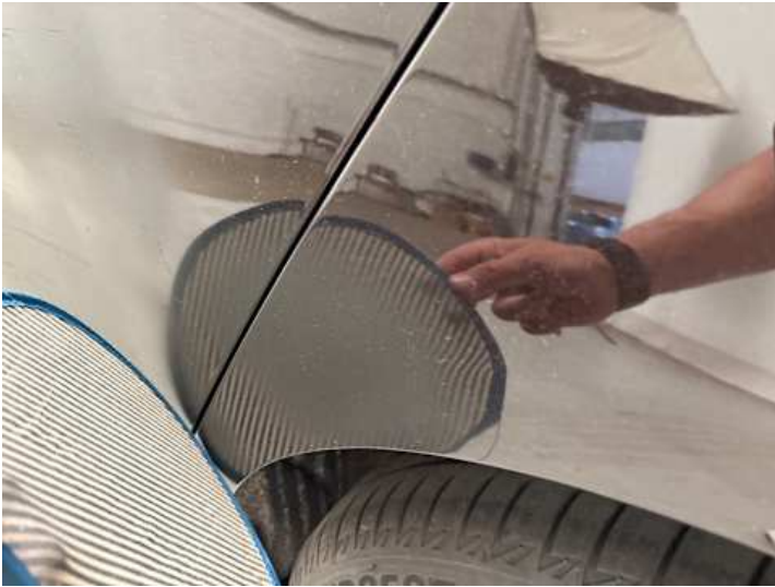
Seitenteil hinten links (Lackschaden, Kratzer, Riss/Bruch)
