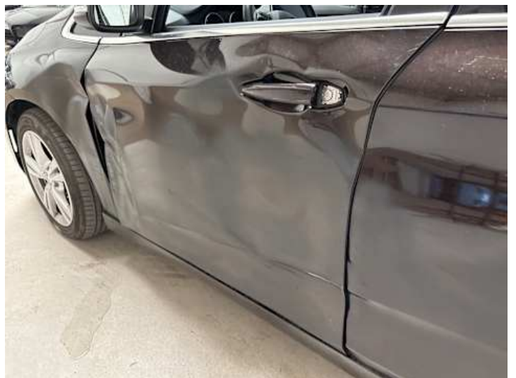
Fahrertür (Lackschaden, Verformung, Kratzer)
