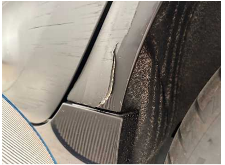
Seitenteil hinten links (Lackschaden, Kratzer, Riss/Bruch)
