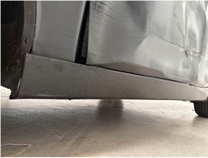
Schweller links (Lackschaden, Kratzer)
