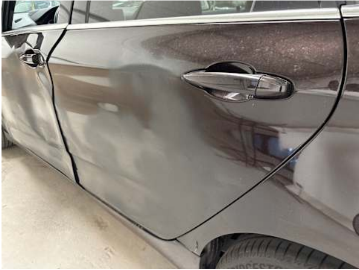
Türe hinten links (Lackschaden, Kratzer, Verformung)
