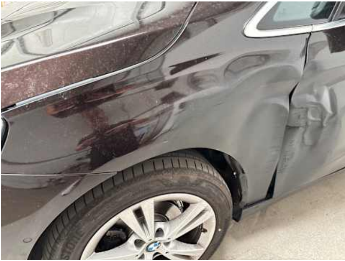
Kotflügel vorne links (Lackschaden, Verformung, Kratzer, Spaltmaße ungenau)
