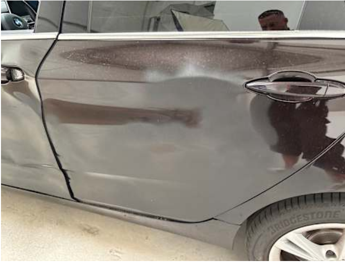
Türe hinten links (Lackschaden, Kratzer, Verformung)
