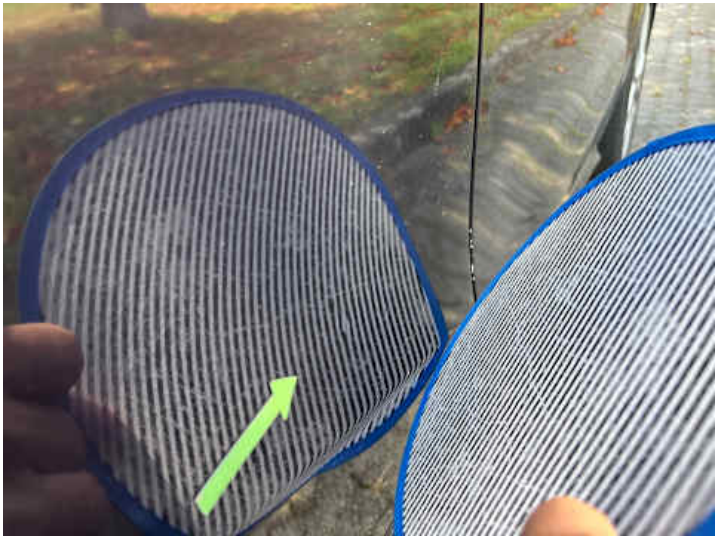
Türe hinten rechts (Delle)
