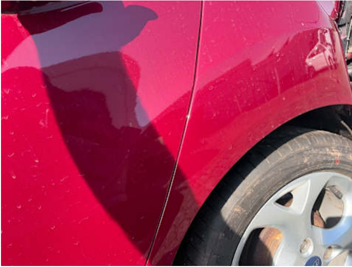
Türe hinten links (Spaltmaße ungenau)
