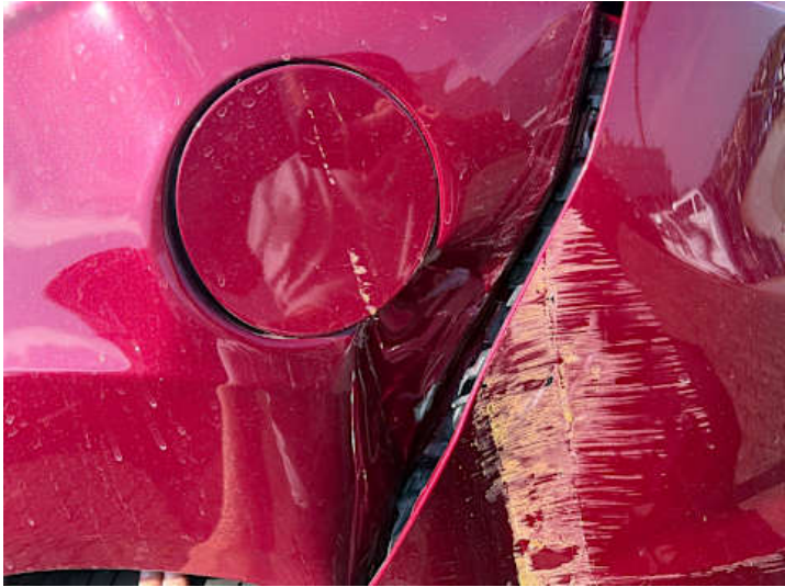
Seitenteil hinten links (Verformung, Lackschaden, Riss/Bruch)
