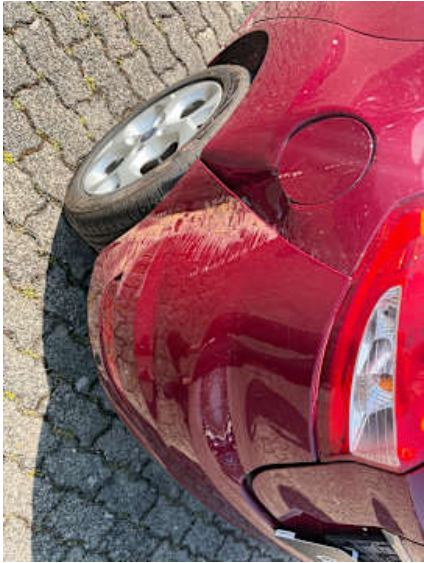
Stoßstange hinten (Lackschaden, Verformung, Riss/Bruch, Spaltmaße ungenau)
