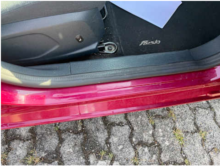
Schweller rechts (Kratzer)
