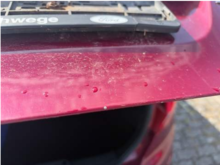
Heckklappe (Steinschlag, Lackschaden)
