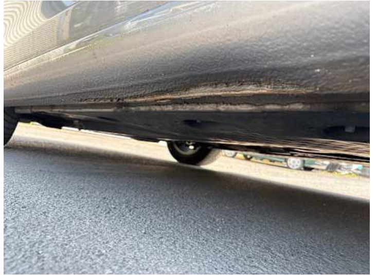
Schweller links (Verformung)
