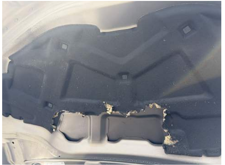
Motorhaube (Anderer Schaden): Dämmmatte beschädigt
