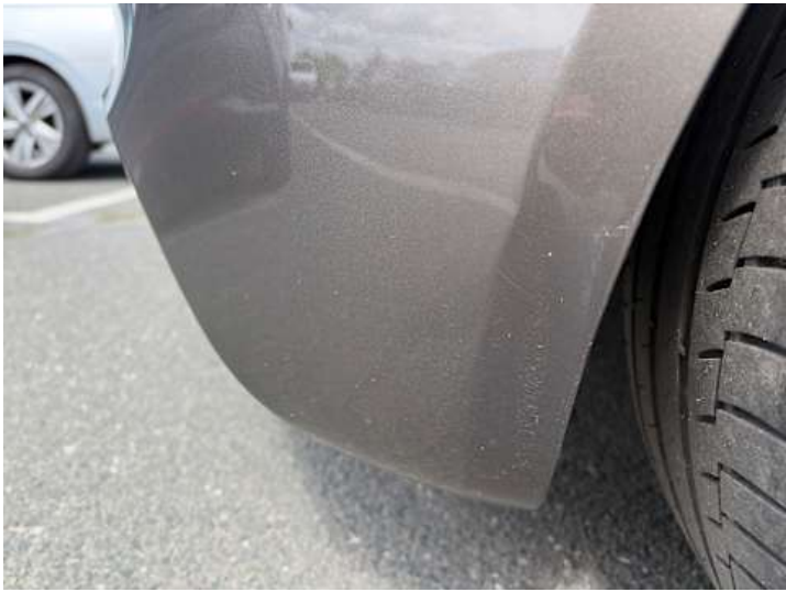
Stoßstange hinten (Lackschaden)
