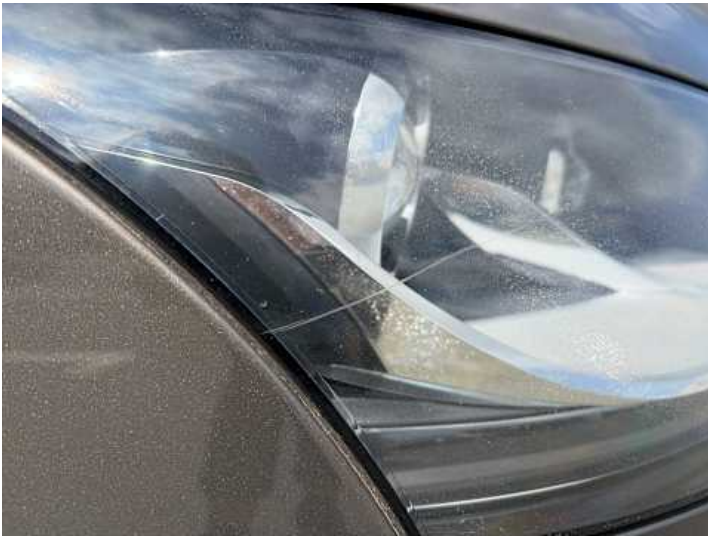
Scheinwerfer (rechts) (Riss/Bruch)
